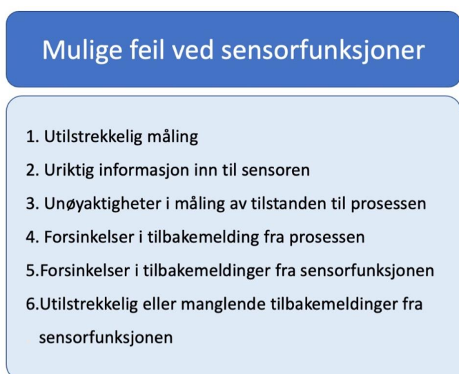
Figur 3.4. Oversikt over mulige feil ved sensor funksjoner. Dersom en av disse feilene oppstår vil prosessmodellen til kontrolleren vike fra den virkelige tilstanden. Dette kan føre til manglende sikkerhetsbegrensninger og uønskede hendelser. (Njå et al., 2020, s. 272-273).
