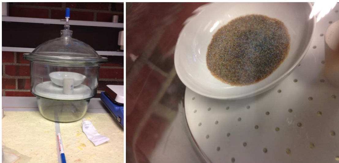
Figur 3.6: Til venstre desikator. Til høyre silika i en skål som vil suge opp fuktighet fra kritt-kjernen.
