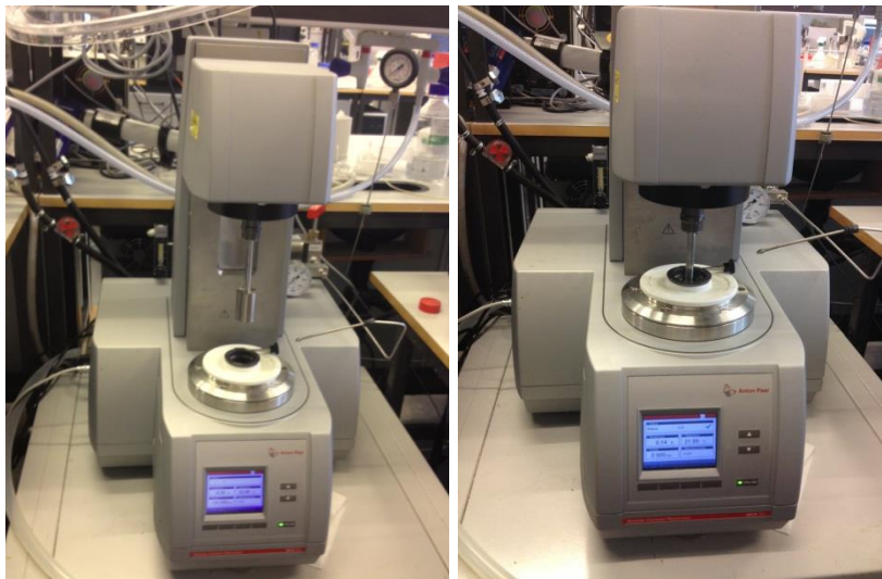
Figur 3.10: Rotasjonsviskosimeter. I bildet til høyre roterer spindelen og tar målinger av skjærrate og skjærspenning.
