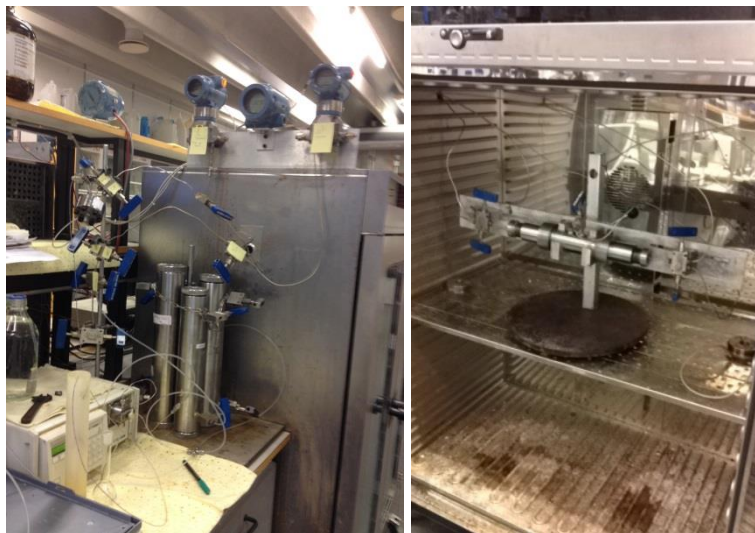
Figur 3.1: Bilde til venstre viser en hvit kasse som er pumpen, et avløpsvann-beger med måling og mange ventiler til og fra kjerneholderen. Bildet til høyre viser en kjerneholder, der destillert vann strømmer gjennom.
