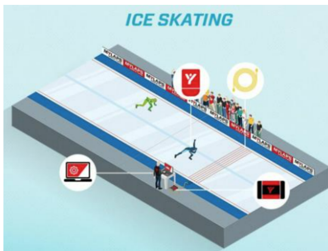
Figur 2.5: Figuren illustrerer prinsippet bak mylaps systemet sett fra skøyteperspektiv. Passeringen leses av ved hjelp av en sløyfe i isen tilkoblet en dekodeer og datamaskin[7].
