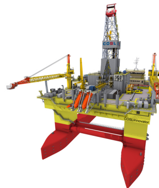
Figur 26: Bilde av en halvt nedsenkbar plattform (flyter) COSL Innovator 24
