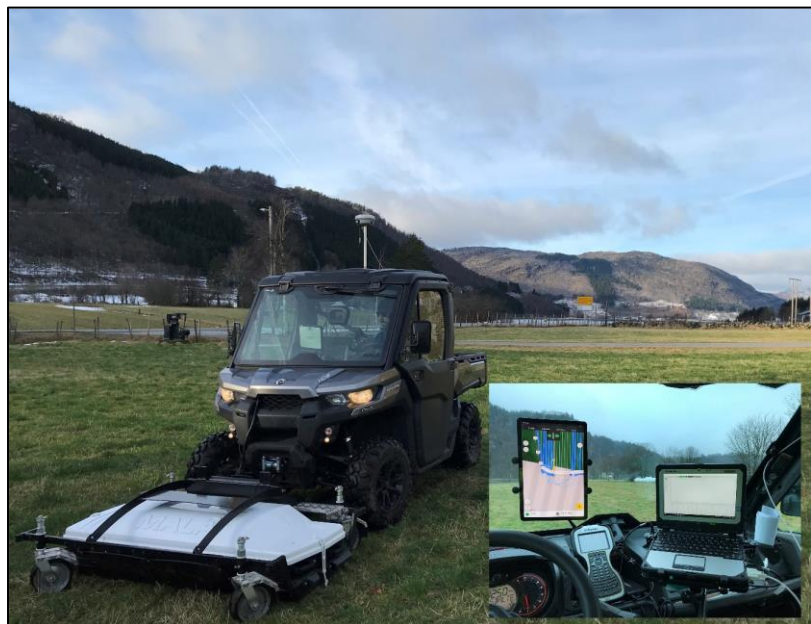
Figur 6: Utstyret som ble brukt på undersøkelsene. Malå Mira montert foran på en firehjuling (Foto: AM, UiS).
