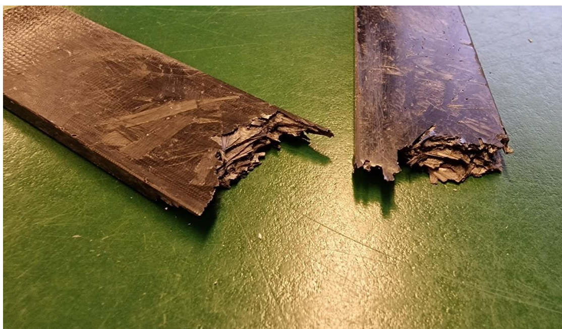
Bilde 6.2. Bruddflate på strekkprøve fra aluminiumsform.
