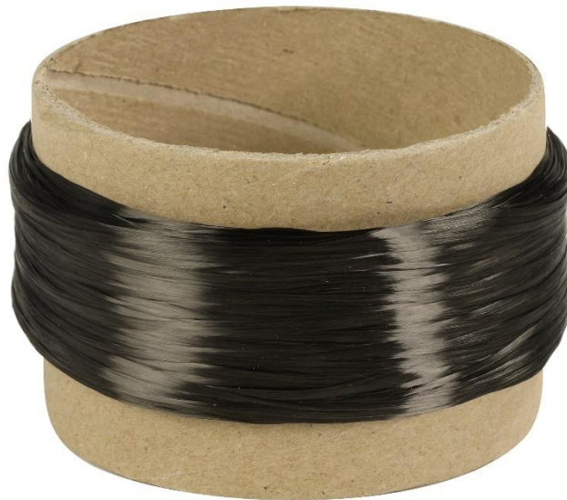
Bilde 4.2. Ferdig behandlet karbonfiber tred på rull. [3]
