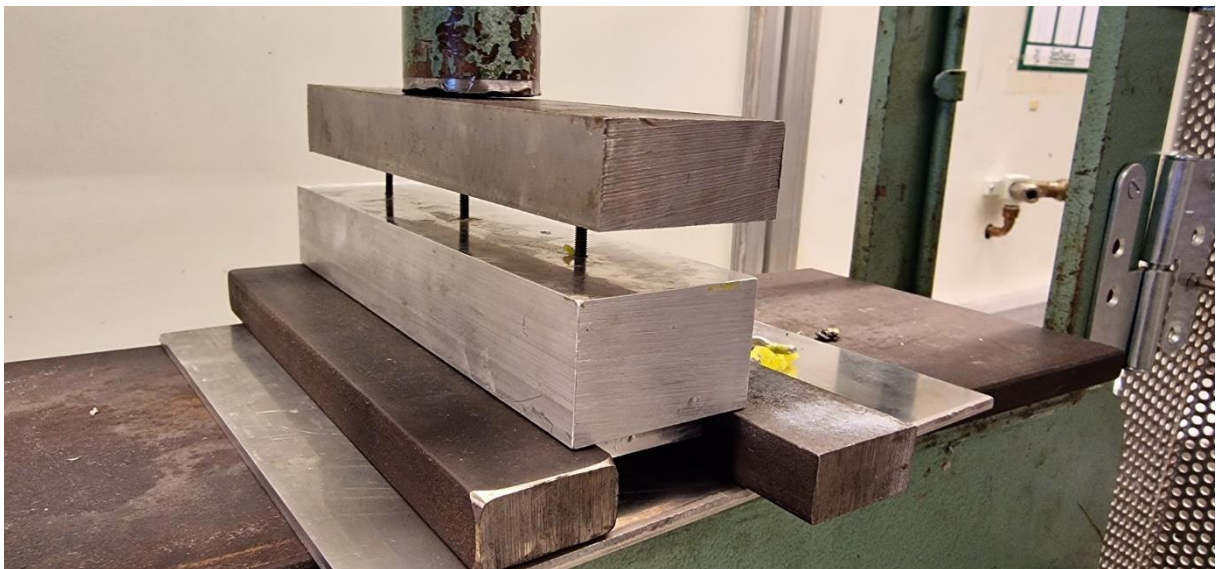
Bilde 5.18. Demontering av støpeform i presse
