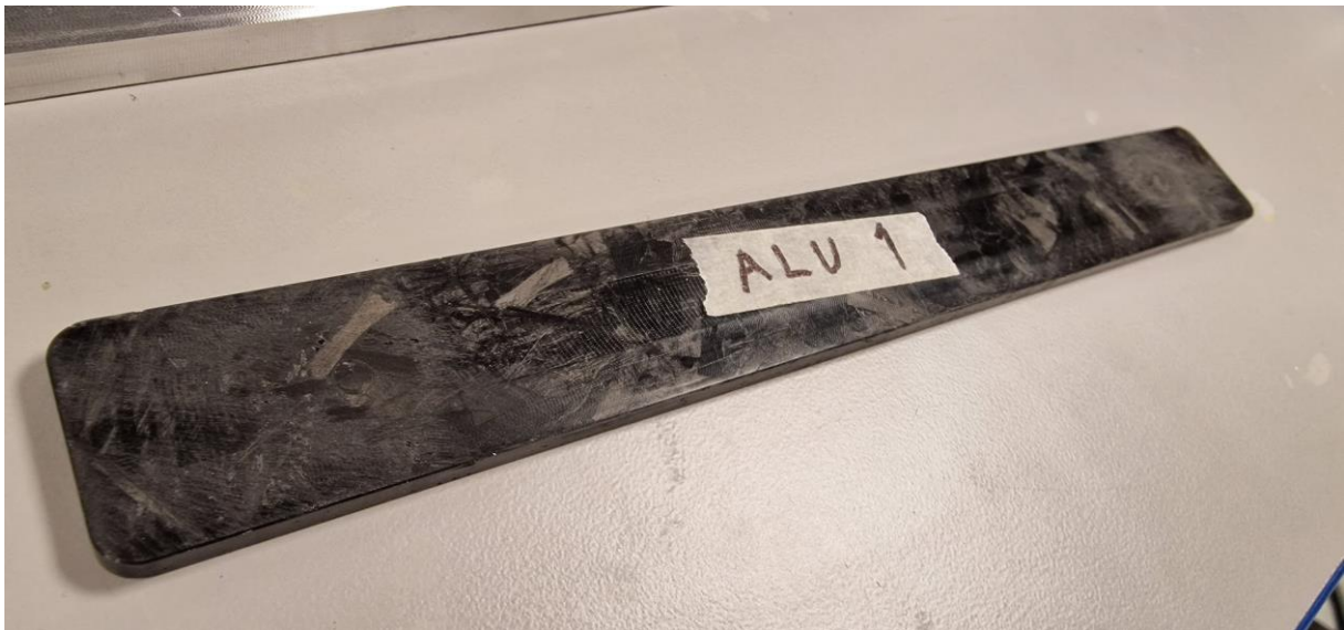
Bilde 5.20. Ferdig preparert strekkprøve fra form i aluminium.
