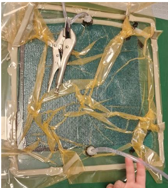
Bilde 4.4. Vakuuminfusjon utført på Universitetet i Stavanger av ION Racing.
