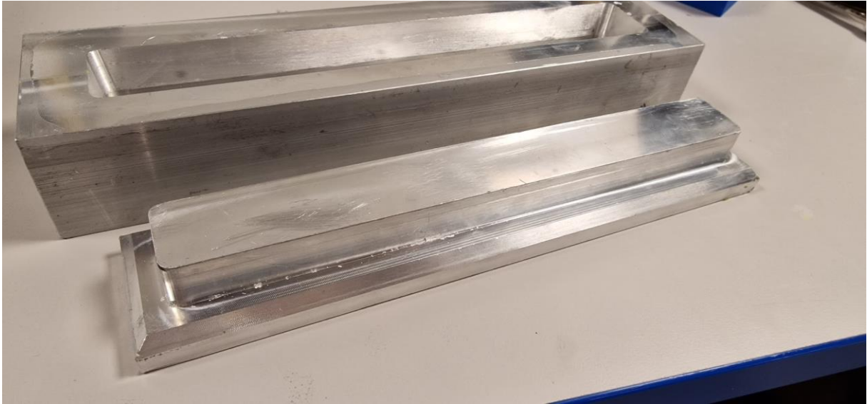
Bilde 5.8. Overdel av form maskinert i aluminium til strekkprøver.
