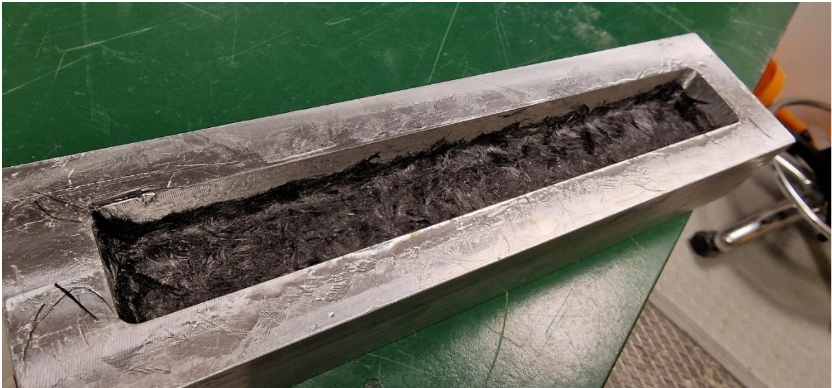
Bilde 5.15. Slik ser støpingen ut når fibrene er lagt jevnt og alle fibrene er helt fuktet i epoxy resin.
