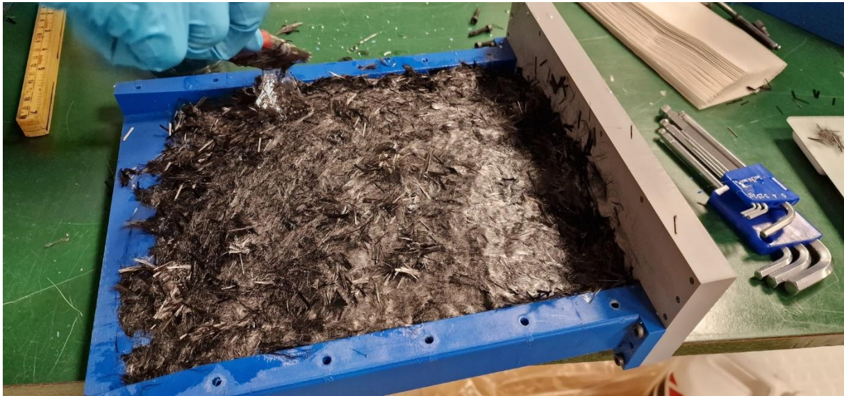
Bilde 5.23 Støping av emnet til strekkstaver.
