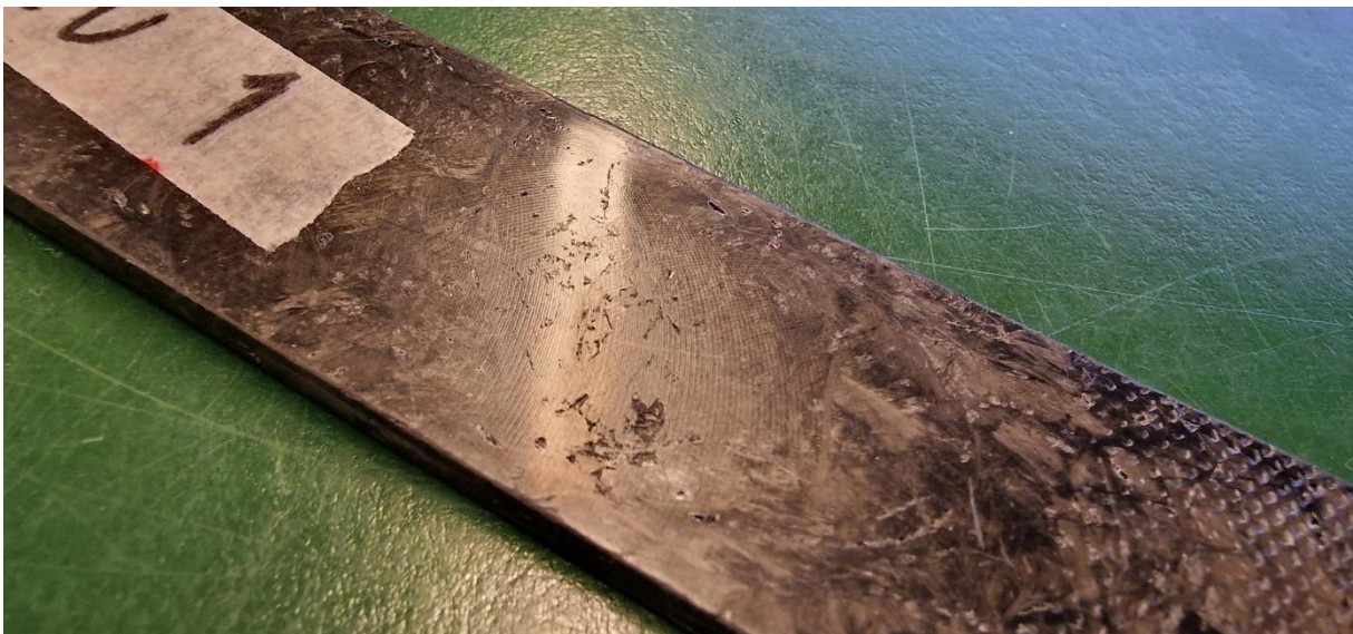
Bilde 7.1. Porer på størrelse under 1mm kan ses i overflaten av strekkprøven.
