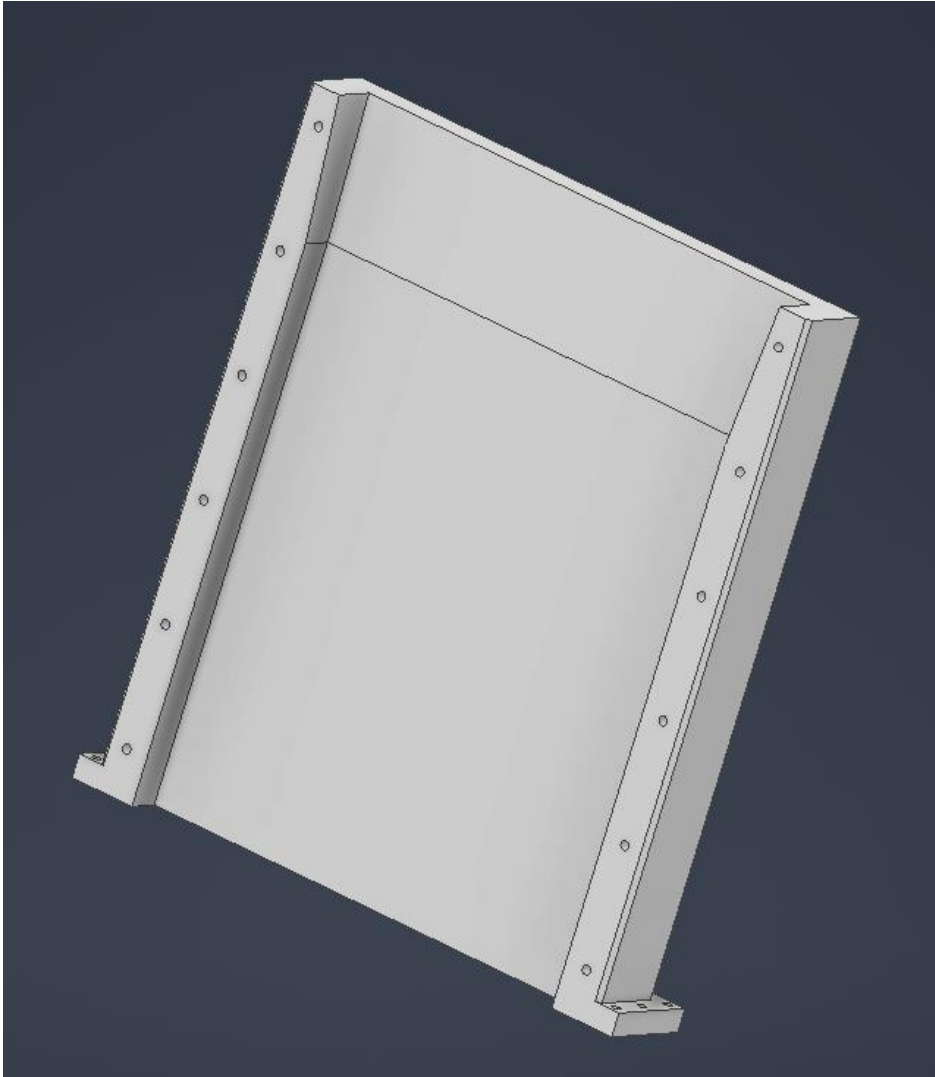
Bilde 5.11. Bundelen av formen til emnet for strekktester.
