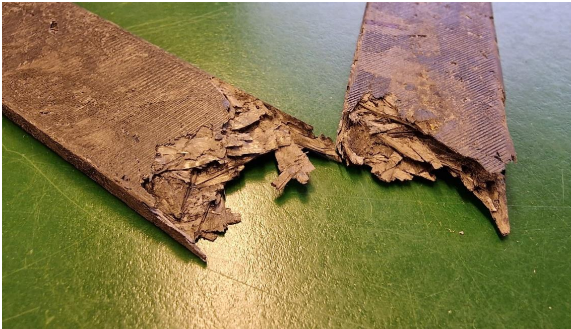
Bilde 6.1. Bruddflate på strekkprøve fra 3dprintet form.
