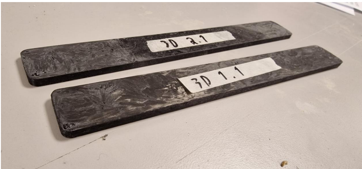
Bilde 5.22. Ferdig preparert strekkprøve fra 3dprintet form. Merket med form den er støpt i og nummer på testen.
