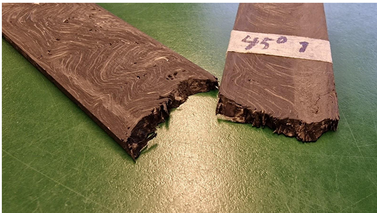
Bilde 6.4. Bruddflate på strekkprøve maskinert ut av emne i 45°.
