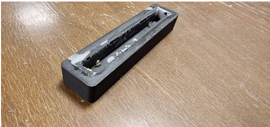
Bilde 5.34. Støpeform brukt til å lage prøvestykker for bøyetest.
