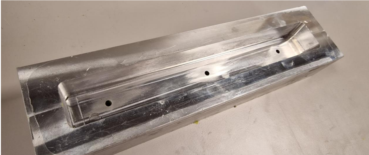
Bilde 5.4. Bunn del av støpeform maskinert i aluminium til strekkprøver.
