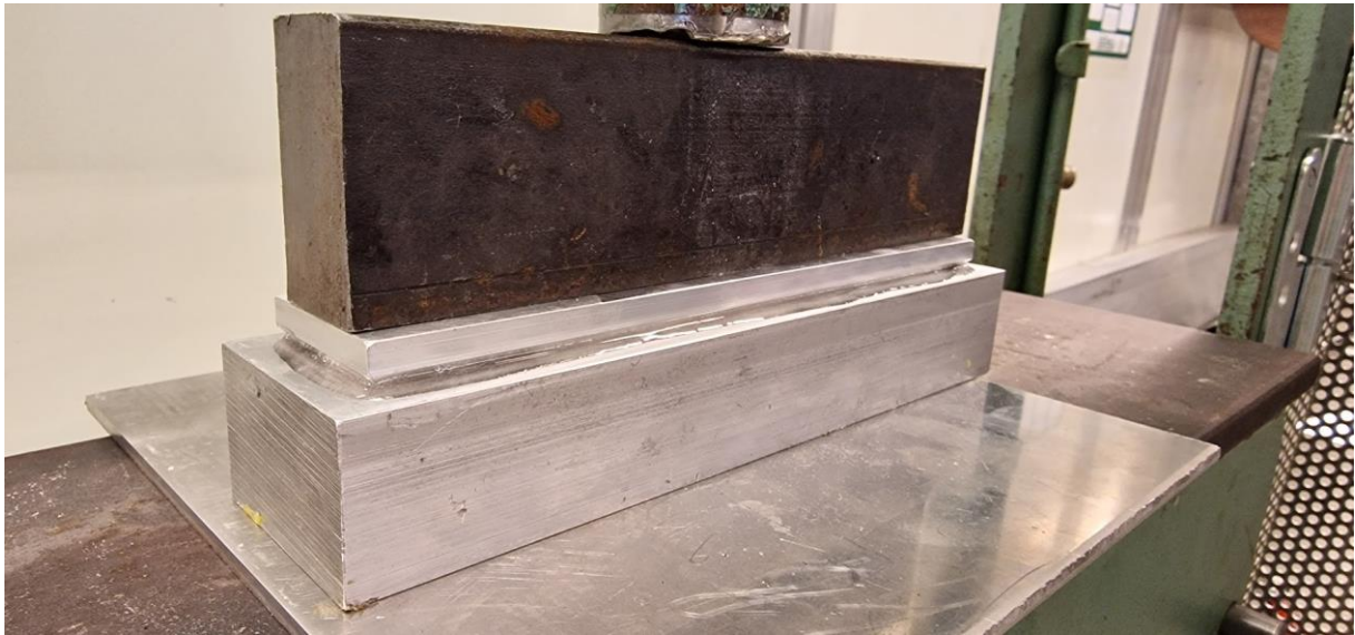
Bilde 5.17. Støpeform komprimert i presse.
