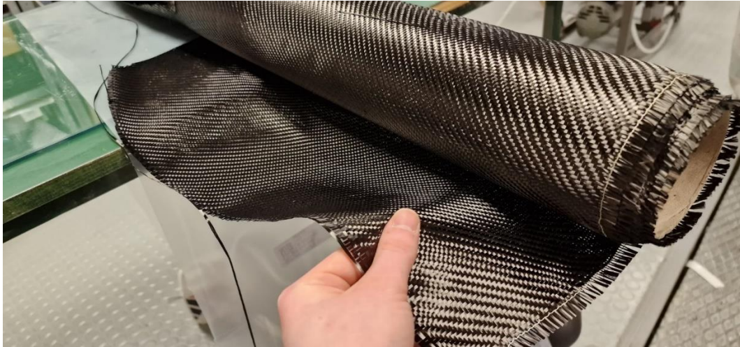
Bilde 4.3. Standard karbonfiberduk som brukes til diverse på ION Racing bil.
