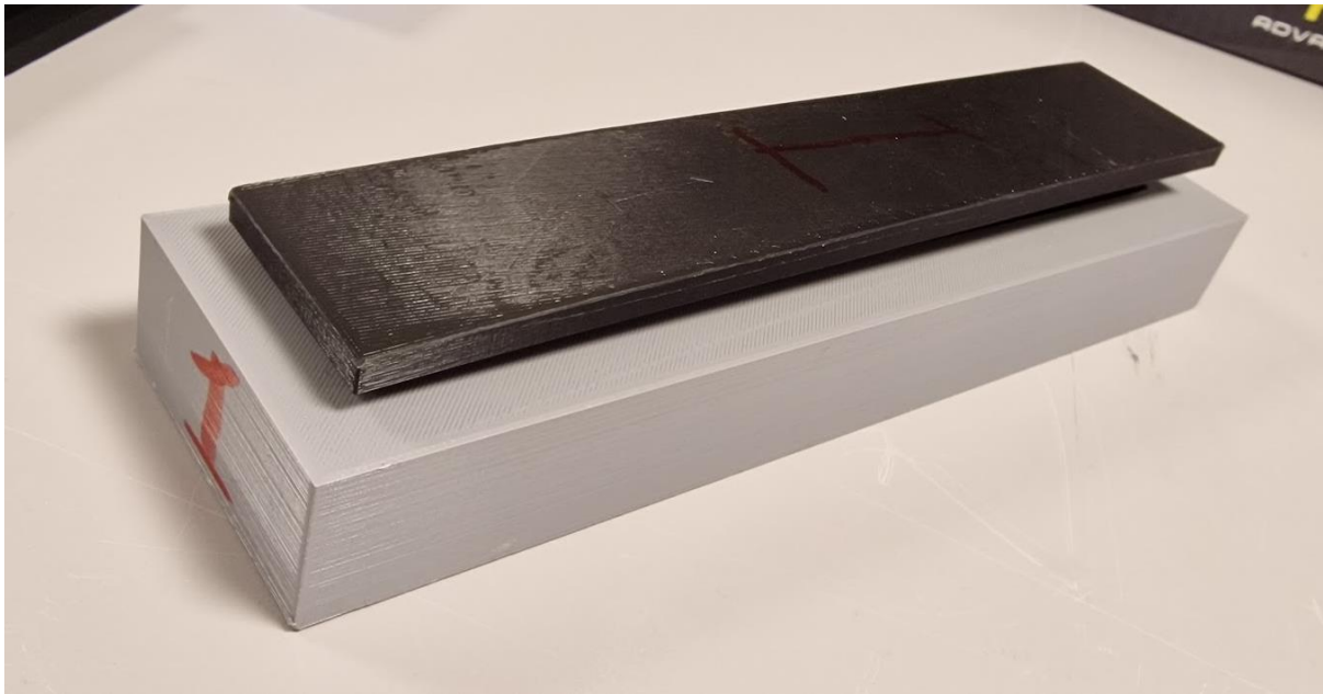
Bilde 5.10. De 2 delene av formen til strekkprøvene med overdel og underdel satt sammen i komprimert stilling. Formene er merket med nummer for å kunne studere om resultat fra strekkprøving har sammenheng med formen den var støpt i.
