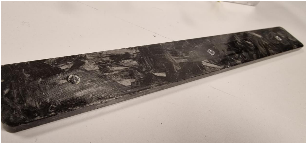
Bilde 5.19. Strekkprøve rett fra form uten noe form for bearbeiding.
