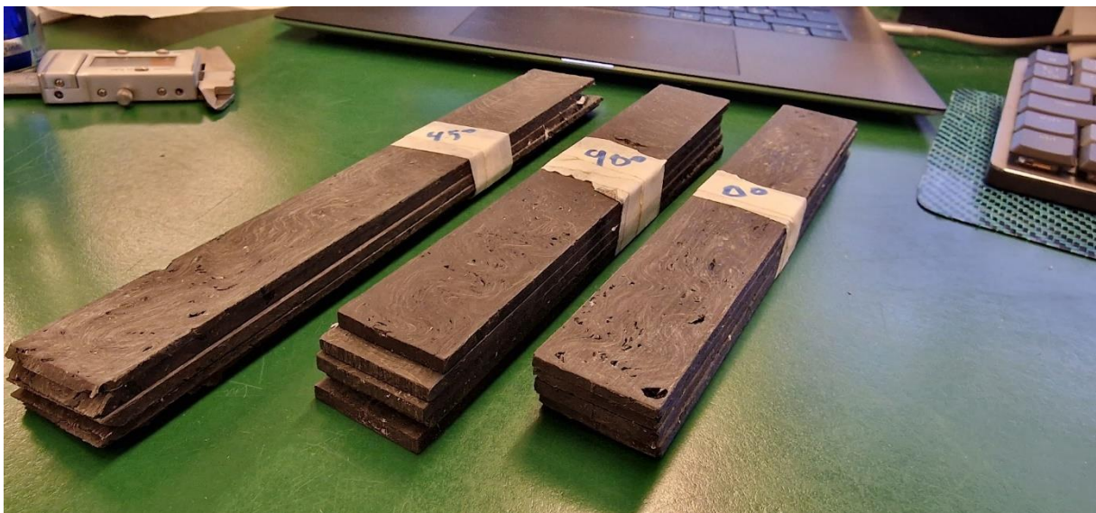
Bilde 5.28. Ferdigkappede strekkprøver, merket med grader de er kappet i.
