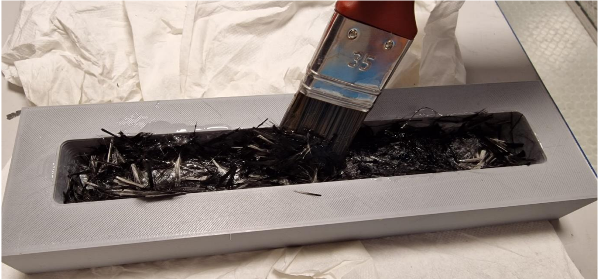
Bilde 5.14. Karbonfiber og epoxy resin som blir lagt lagvis i 3dpritet form.
