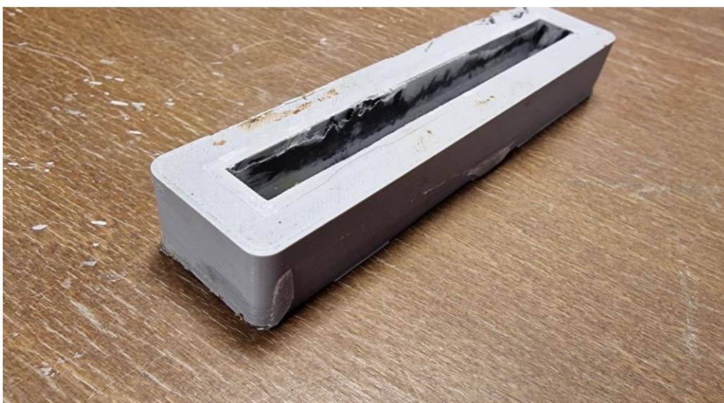
Bilde 5.31. Støpeform brukt til å lage prøvestykker for kompresjonstest.
