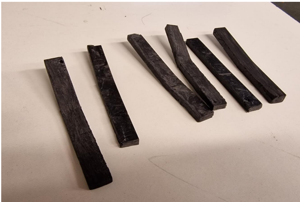
Bilde 5.36. Utførte bøyetester.
