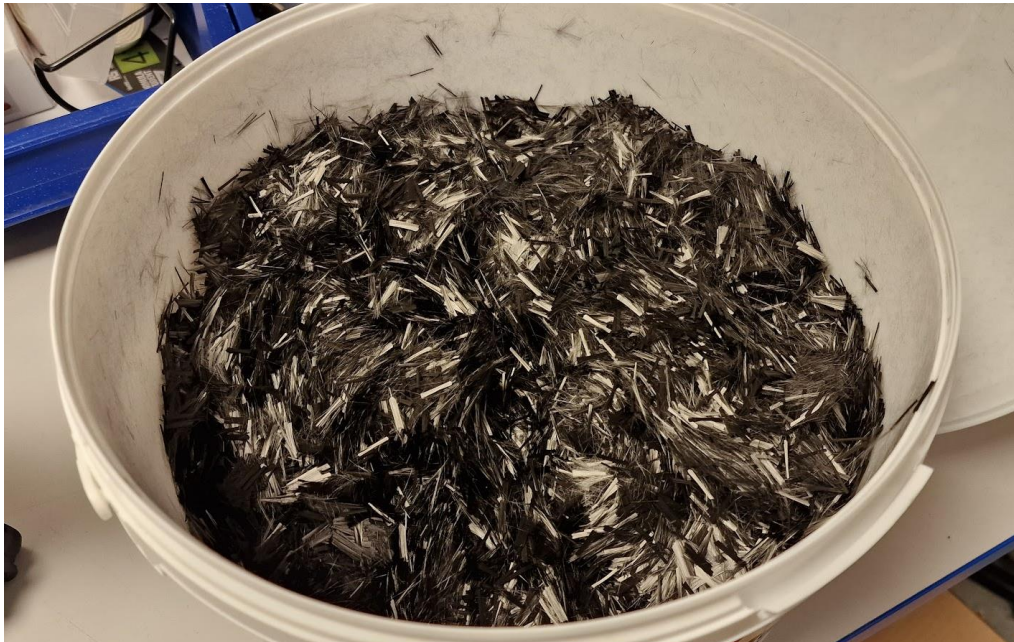
Bilde 4.5. Oppkuttet karbonfiber til diskontinuerlig karbonstøping.
