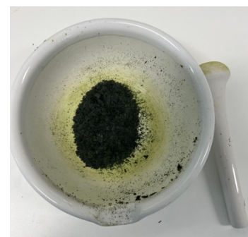
Figur 14 Den tørkede taren fra hovedforsøket ble knust til pulver ved hjelp av en morter.
