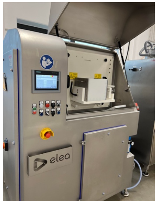
Figur 10 Maskin brukt til utførelse av Pulserende elektrisk felt behandling. Maskinen var levert av Elea.
