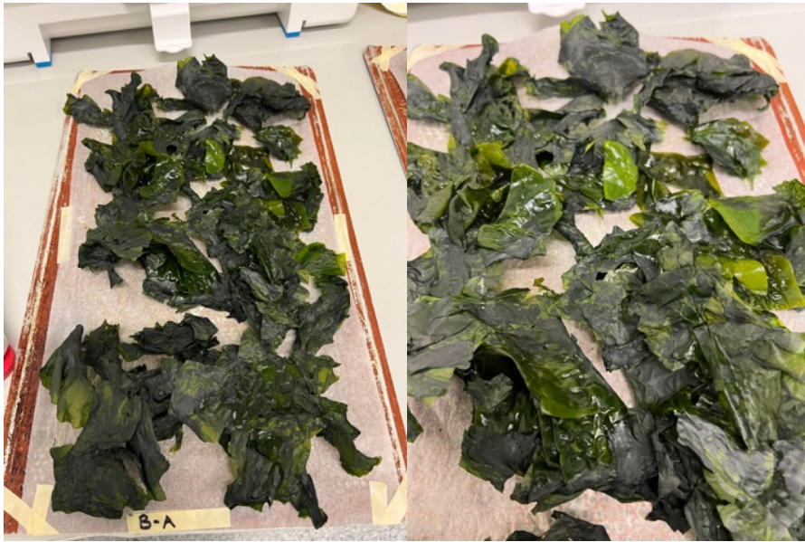
Figur 13 Etter 4 timer tørking ble det oppdaget områder med fukt når taren ble dratt fra hverandre.
