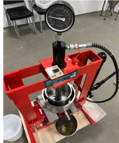
Figur 11 Oppsettet av pressen som ble brukt til mekanisk avvanning. Trykk måleren viser at trykket i pressen var på 3
