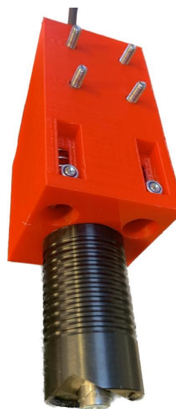
(a) Modell for sensorholder sett fra bunnen (b) S sammensatt og klar for montering på z-aksen
