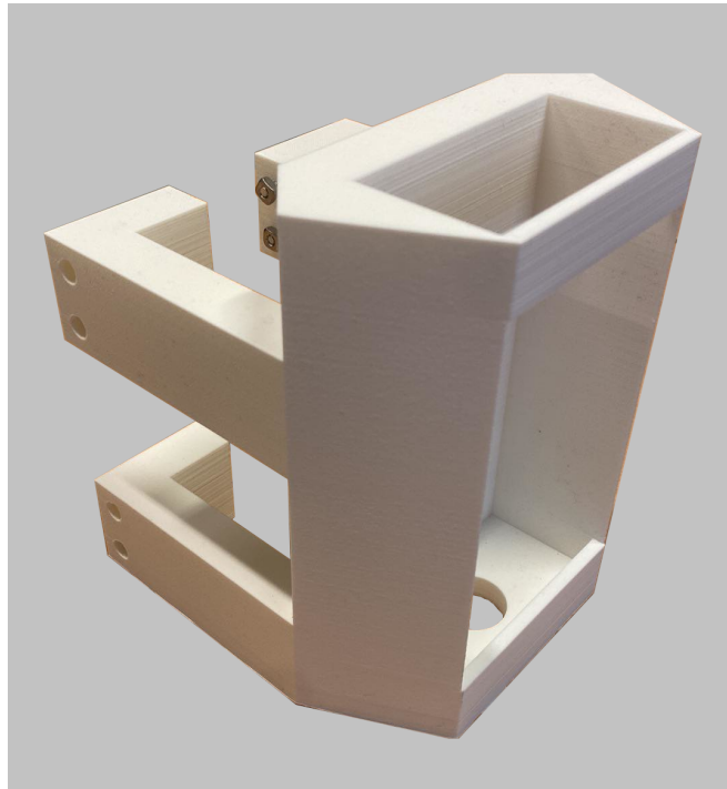
Figur 3.15: Ferdig 3D-printet brakett til Elcometer
