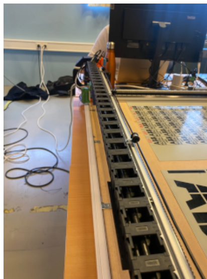
(b) Bevegelig kanal som flytter seg med systemet
