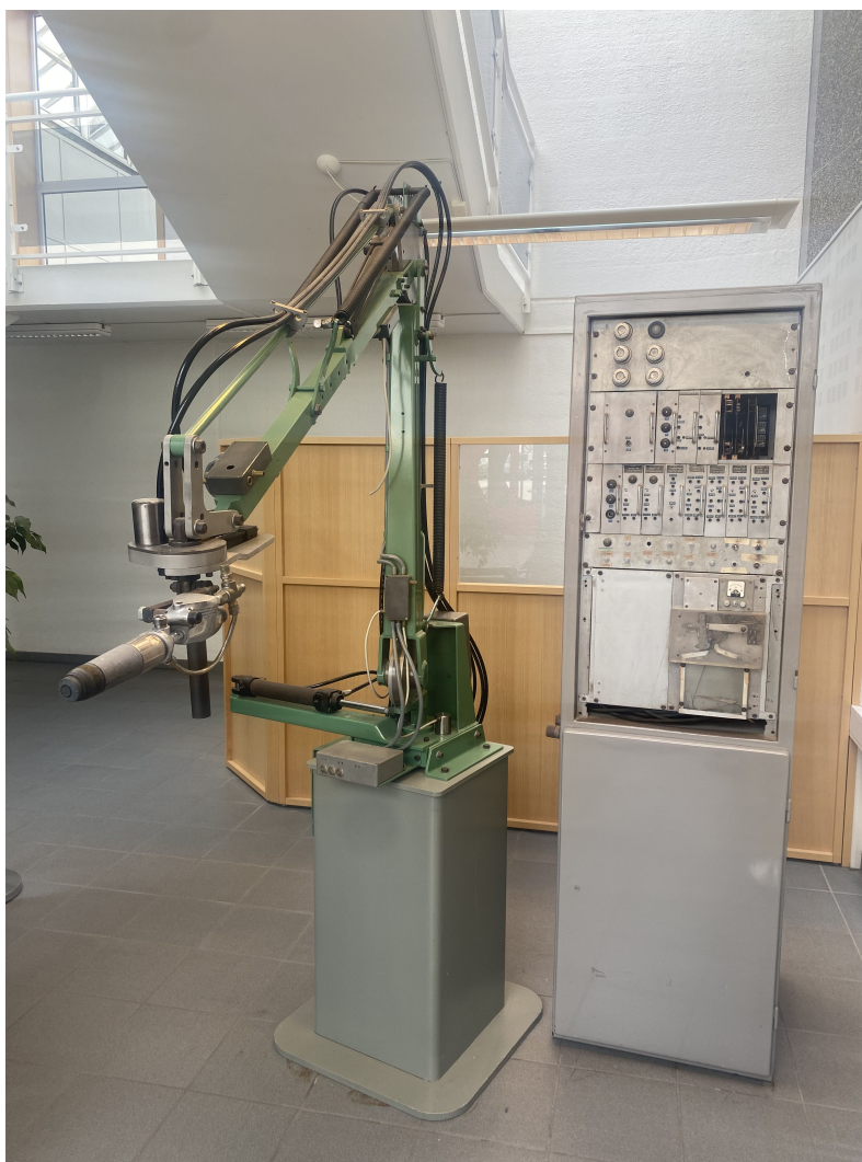
Figur 1.1: Verdens første lakkeringsrobot
