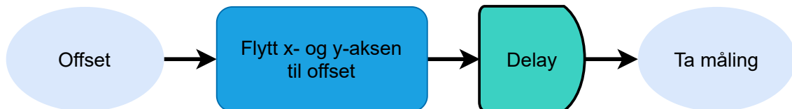
Figur 3.25: Offsetten forskyver hele målesetter slik at målingene havner midt på platen det måles over
