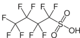
Figure 2-4. PFBS structure («Perfluorbutansulfonsäure», 2021)
