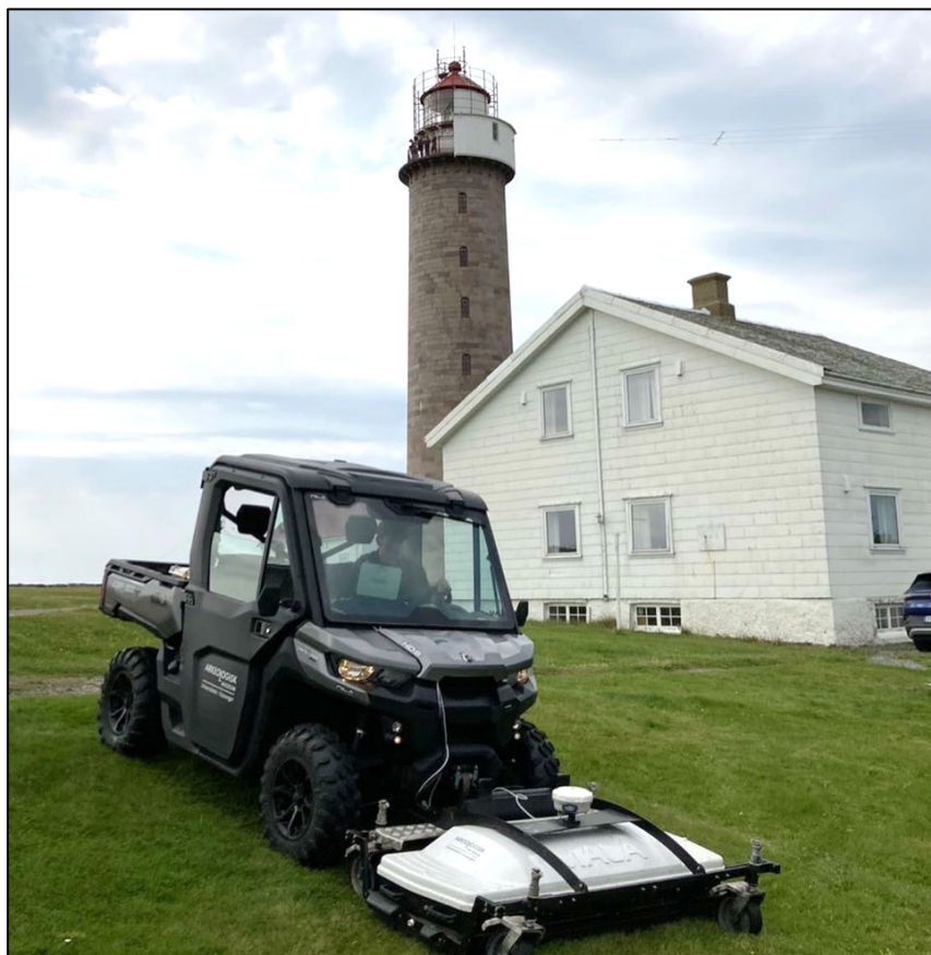
Figur 11: Utstyret som ble brukt på undersøkelsene. Malå Mira montert foran på en firehjuling (Foto: AM, UiS).
