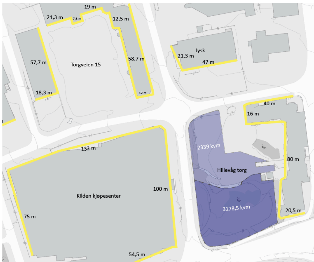
Figur 4.13: Fasadelengdene som rammer inn byrommet i Hillevåg bydelssentrum. Målene viser at fasadene har få eller ingen avbrekk og lite variasjon med lange sammenhengende volum. Arealet som er satt av til allsidig bruk for innbyggerne på Hillevåg torg er 5,5 mål som tilsvarer en fotballbane.
