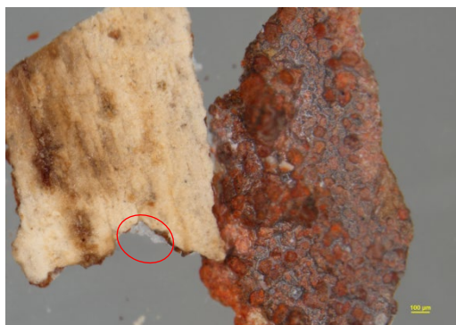
Fig. 40. Nordvegg, Fragment fra S. Malachias kjortel. Krystaller som indikerer bruk av Calaton observert (merket med rødt).
