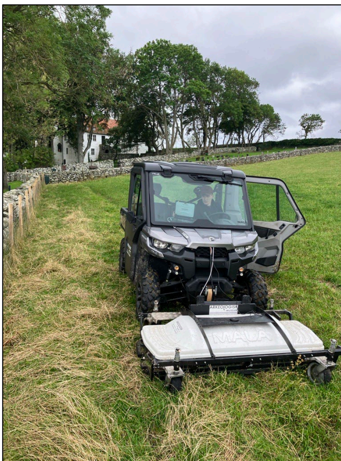
Figur 24: Utstyret som ble brukt på undersøkelsene. Malå Mira montert foran på en firehjuling, her fra undersøkelser av område 2 på Utstein. Klosteret kan skimtes i bakgrunnen (Foto: Grethe M. Pedersen, Arkeologisk museum, UiS).
