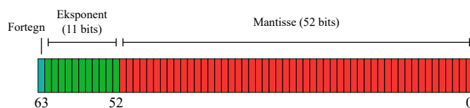
Figur 3.17: Inndeling av bit i et 64-bits flyttall.
