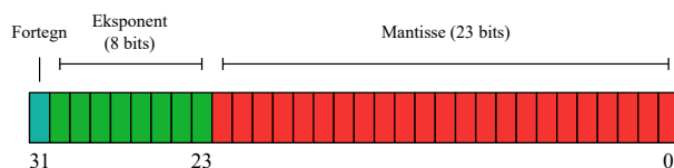
Figur 3.16: Inndeling av bit i et 32-bits flyttall.
