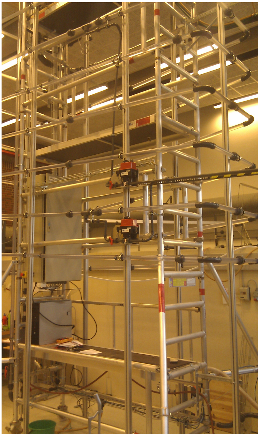
Figur 1.1: Bilde av boreriggmodellen utviklet ved UiS.
