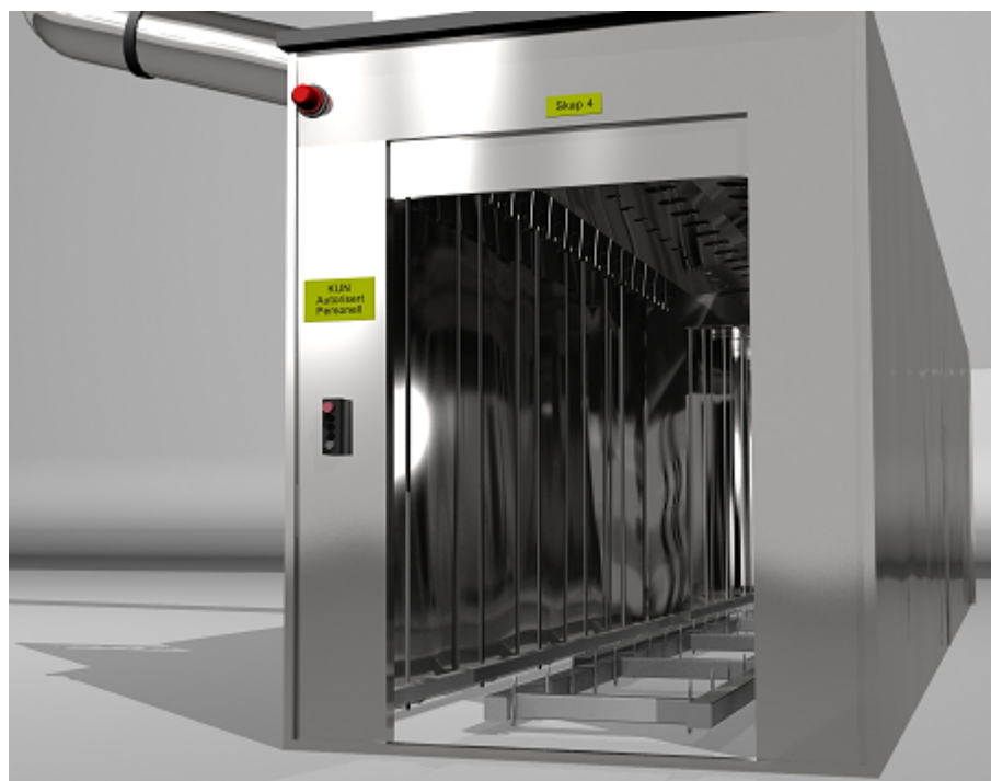
Figur 2.8: Frontpartiet til batchskapet (del-A), hvor trallestativene føres inn.
