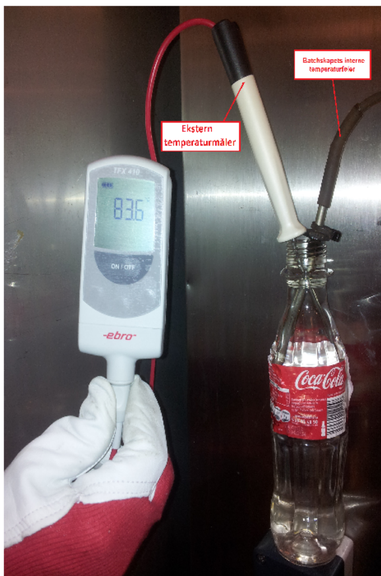
Figur B.6: Kalibrering av temperaturføler i batchskapet.
