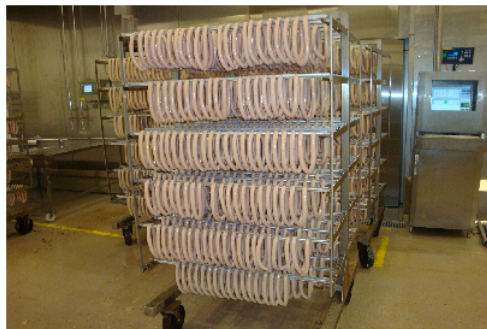
Figur 2.6: Et fullt trallestativ klar for varmebehandling.
