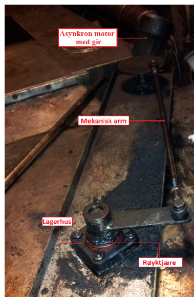
Figur C.1: Her ses vekselspjeldet med asynkron motor og mekanisk arm.
