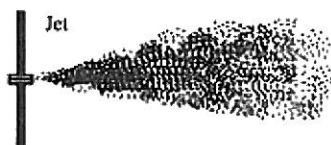
Figur 10 - Jetlekkasje i en flens
