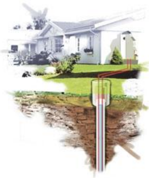
Figur 4.11 Illustrasjon av bergvarmepumpe [41]
