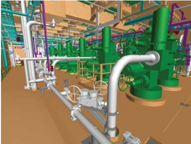
Figur 3 Illustrasjonsbilde av brønnhodeområdet, her fra plattformen Kvitebjørn. Lukedecket skimtes i taket av området (OffshoreMagazine, 2010).
