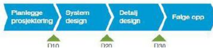
Figur 13. Prosjekteringsprosessen (YIT prosjektmanual)
