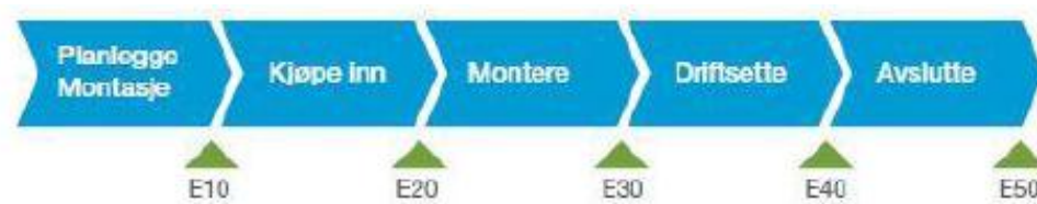
Figur 14. Montasjeprosessen (YIT prosjektmanual)
