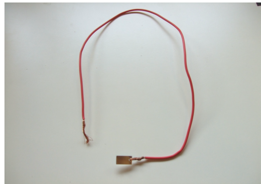
Figur 3.10: 316L prøve klar for testing.
