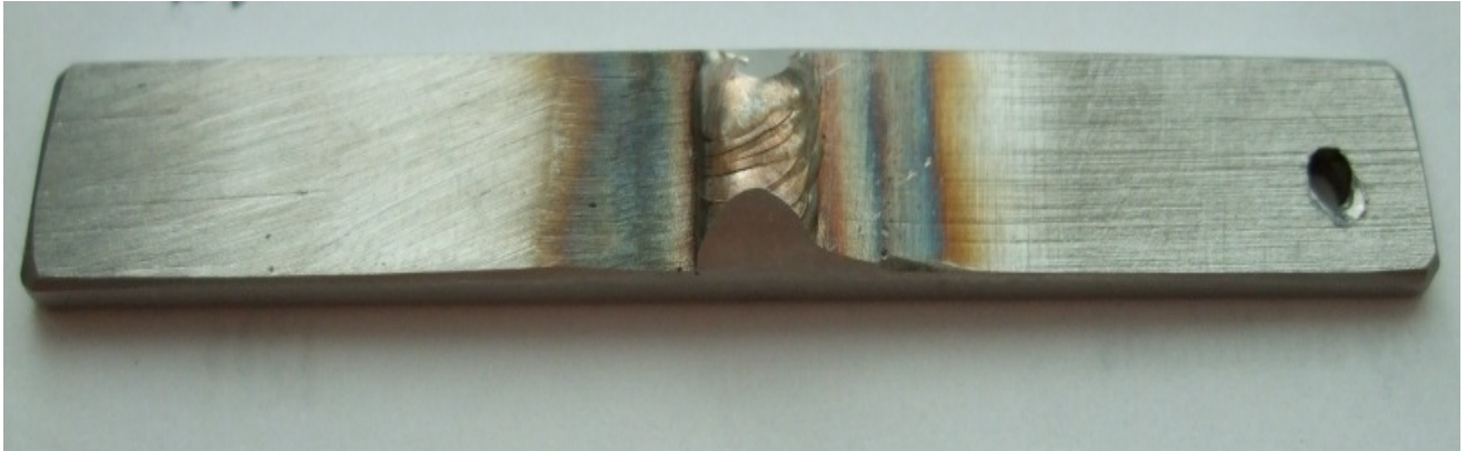
Figur 4.19: Serie 2170 (2205 duplex), parallell 2.
