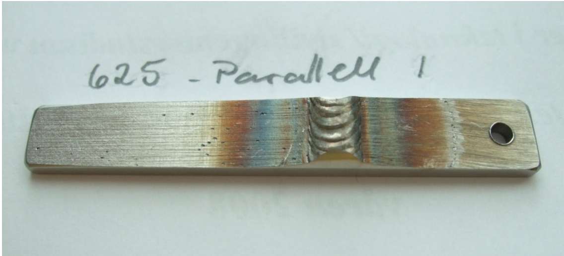
Figur 4.15: Serie 2168 (Alloy 625), parallell 1.
