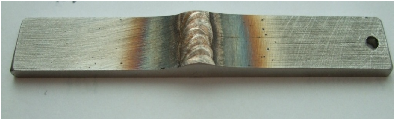
Figur 4.20: Serie 2170 (2205 duplex), parallell 3.
