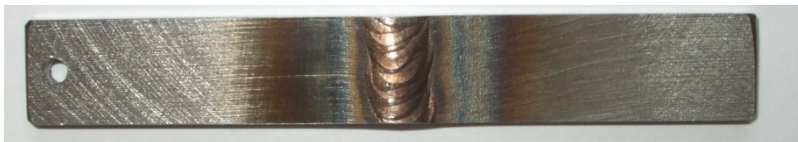
Figur 2.7: Bildet viser misfarging av HAZ i området nær sveisesømmen.
