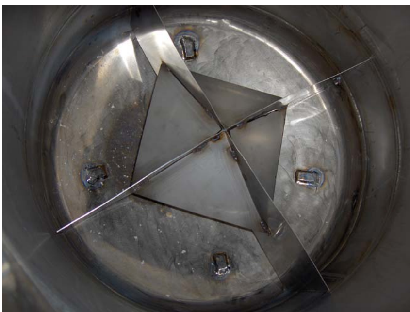
Figur 7-4: Vortex breaker montert i bunnen av flash separatoren
