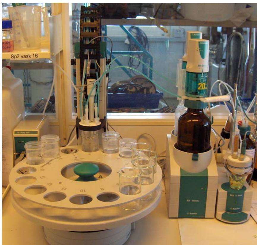
Figur 4-3: Metrohm 814 USB Sample Processor med 836 Titrando for formiatanalyser
