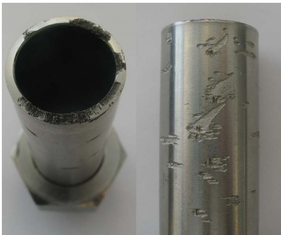
Figur 10-1: Korrosjonsangrep på endestykket på det nedre innløpet i separatoren.
