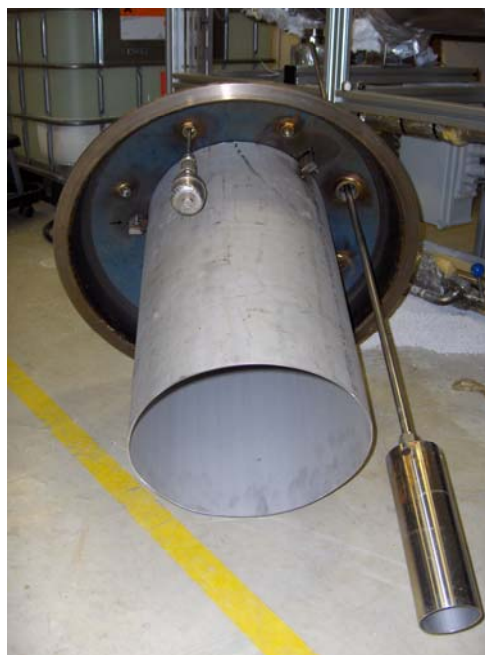
Figur 7-1: Vortex finder montert i lokket til separatoren (stor grå sylinder i midten).
