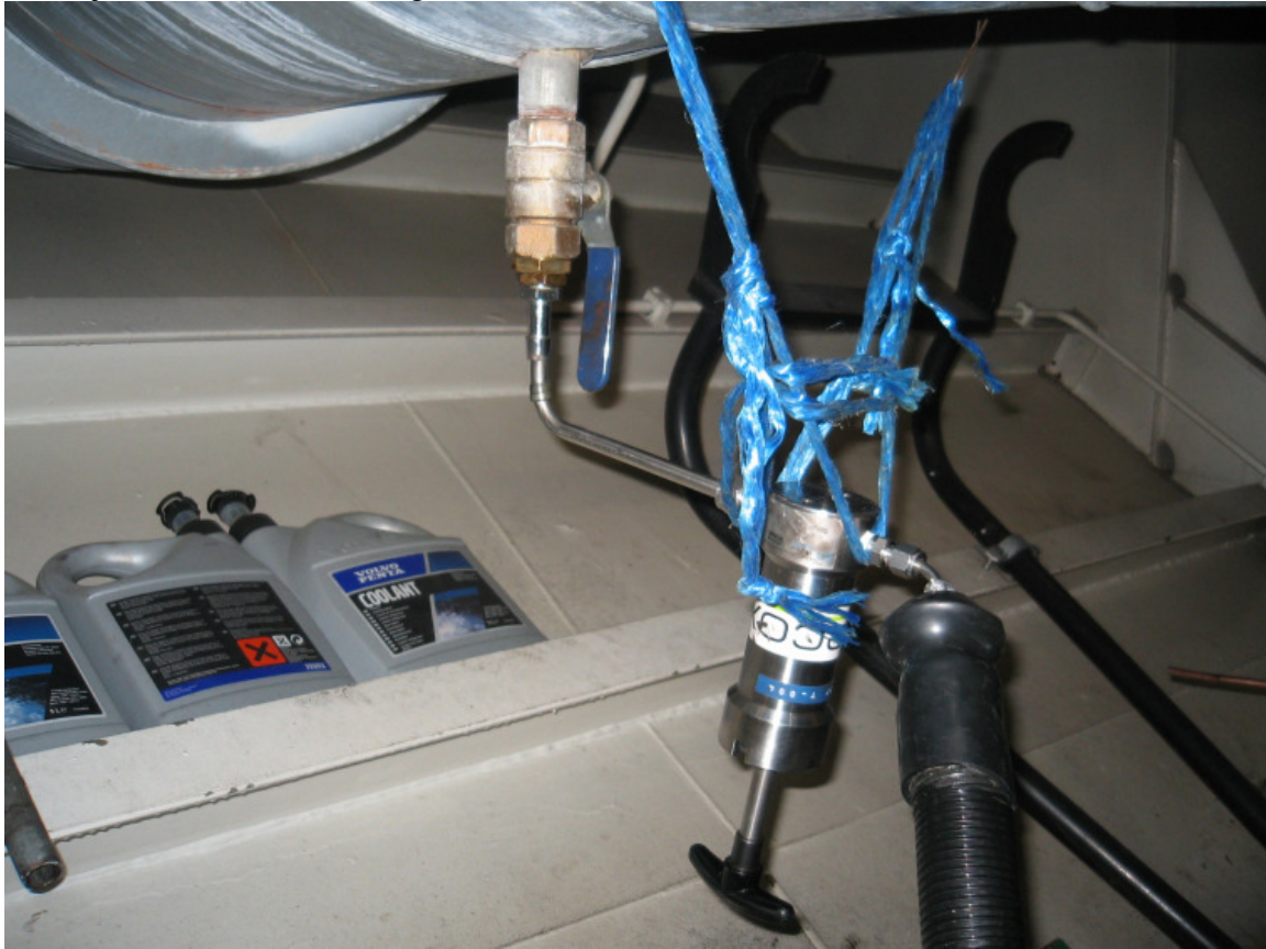
Bilde 8.5. Nærbilde av sonden plassert under avgassrøret ved avgassmåling på fergen "Tresfjord" mellom Molde og Vestnes 08.05.2007.
