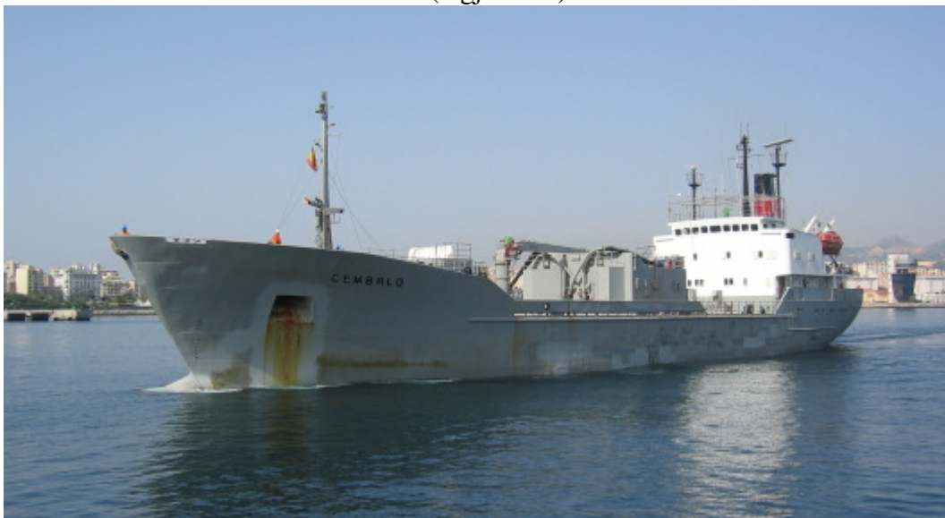
Bilde 2.3. Sementfrakteren Cembalo (Kgjs 2007).
