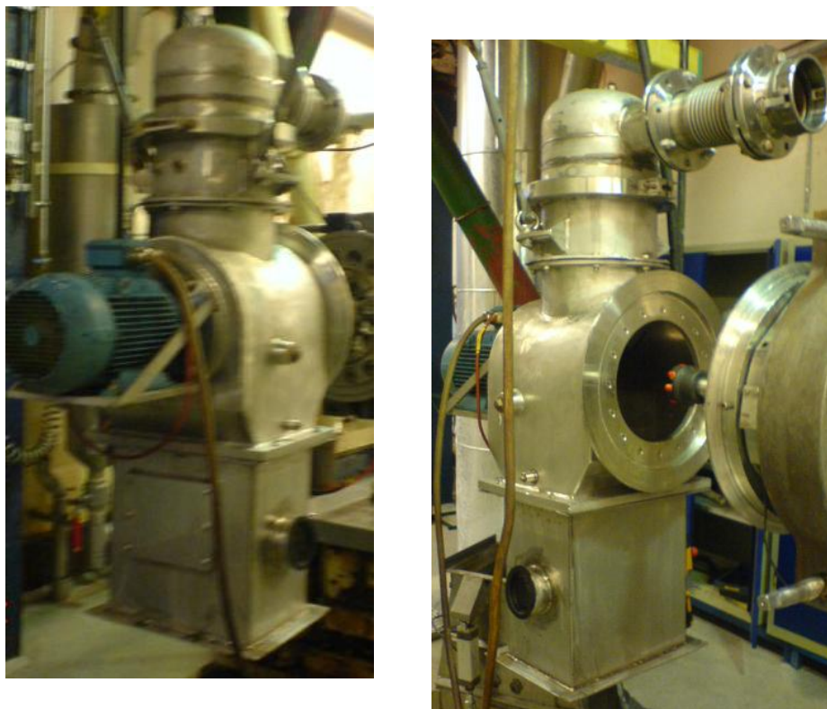
Figur 4.15. Knivkasse. Det venstre bildet viser tydelig hvor motoren som driver knivakselen er festet.
