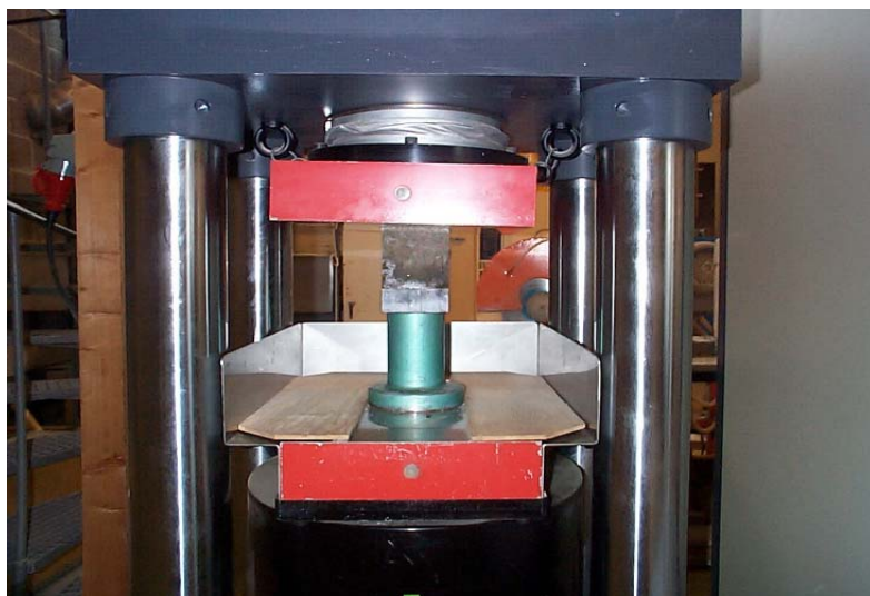
Figur 12 - Trykktest av betongterning
