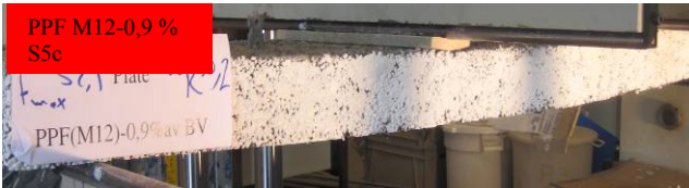
Figur 27 - Deformasjon av Platestripe og rissmønster
