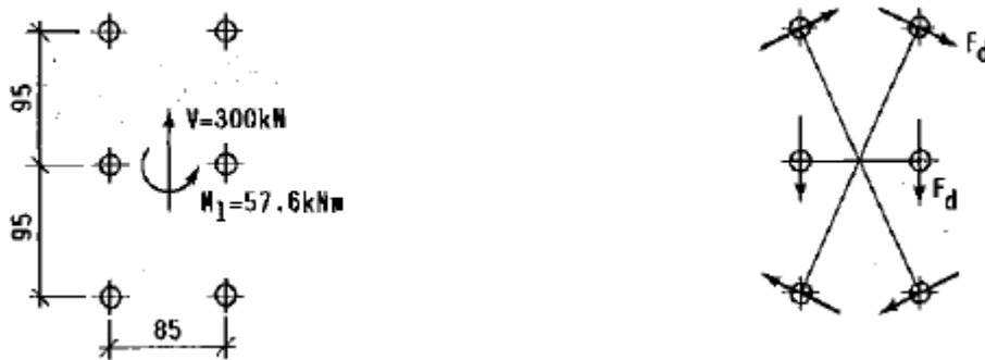
Fig 2.12 Lastfordeling i eksentrisk belastet skruegruppe
