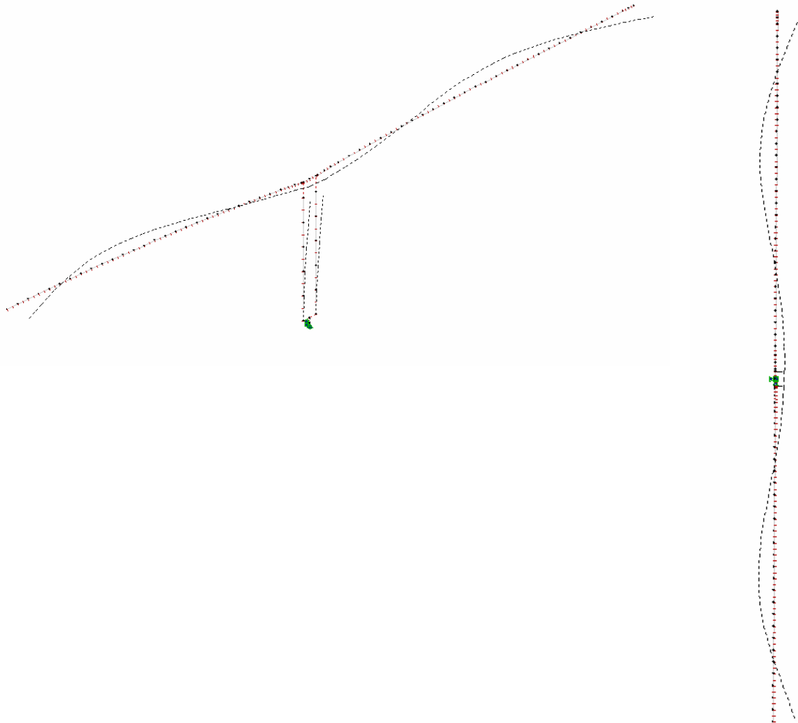
Figur 31 viser svingform 10. Frekvens 2,035 Hz Rotasjon av brubjelken og veggskivene om N-akse. Vist i perspektiv og plan.
