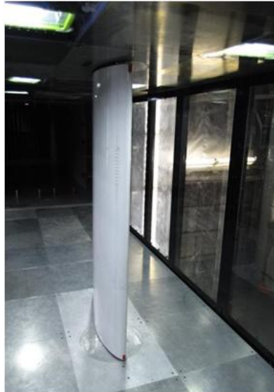
Figur 5.4 Vertikalt bladtesting i vindtunnel [25]
