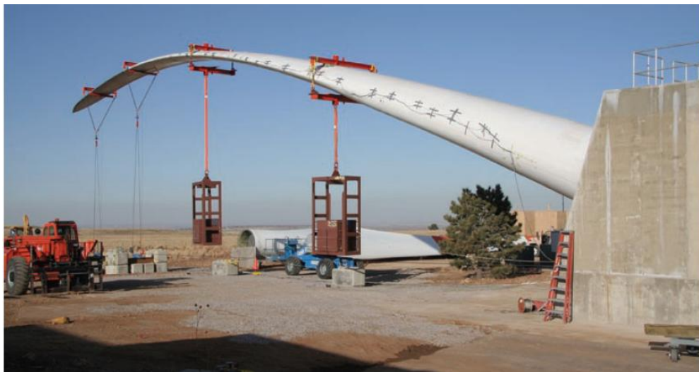
Figur 5.7 Blad test av NREL(National Renewable Energy Laboratory) [26]
