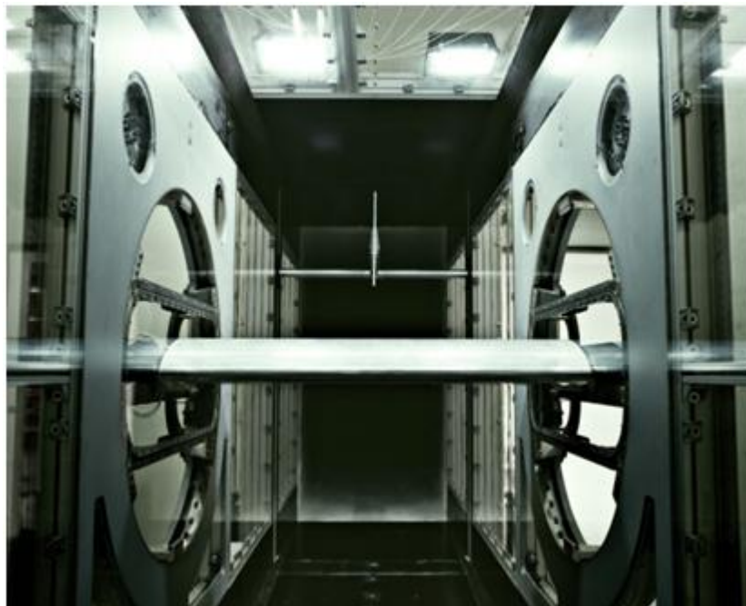
Figur 5.3 Horisontalt bladtesting i vindtunnel [24]
