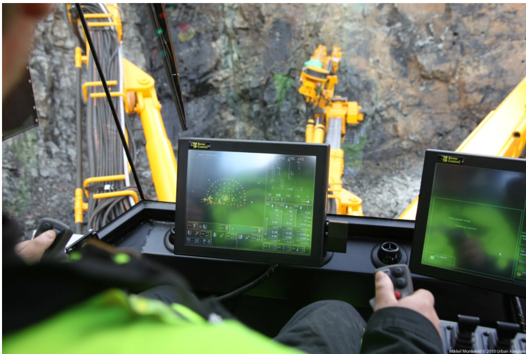
Figur 4 Styringssystem i en AMV borerigg
