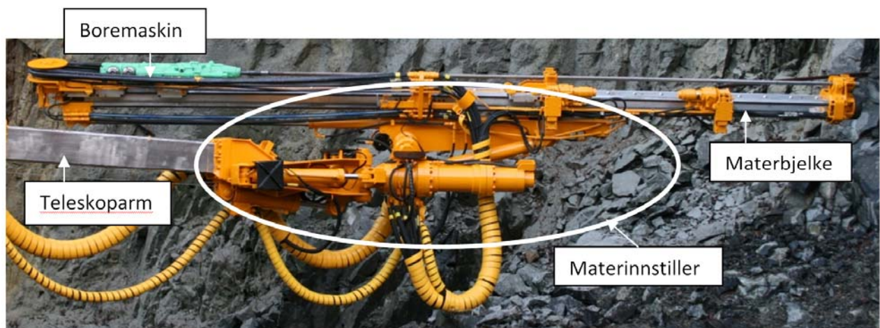
Figur 7 Materinnstilleren på en borerigg
