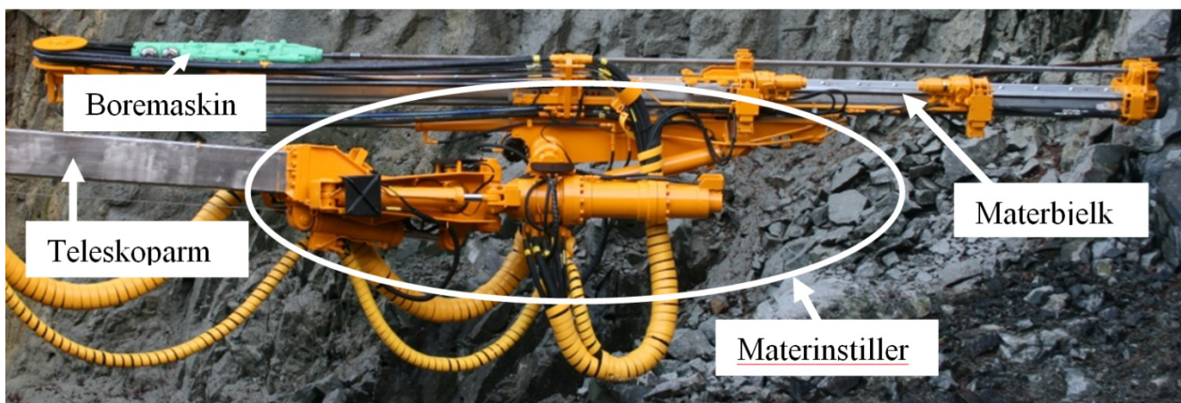
Figur 2 Nærbilde av endestykket på en borebom.
