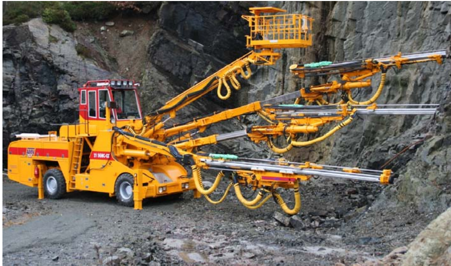
Figur 30 Hydraulikkssystemet med slangepølser langs teleskoparmen
