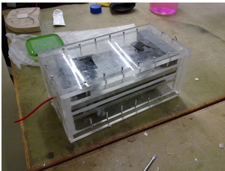
Bilde 3.6: Viser varmepumpen ferdig montert
