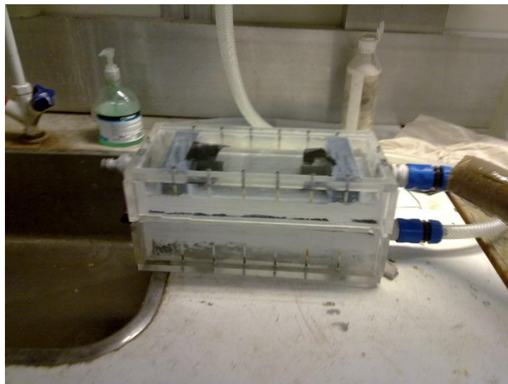
Bilde 4.3: Viser varmepumpe satt sammen etter freseoperasjonen
