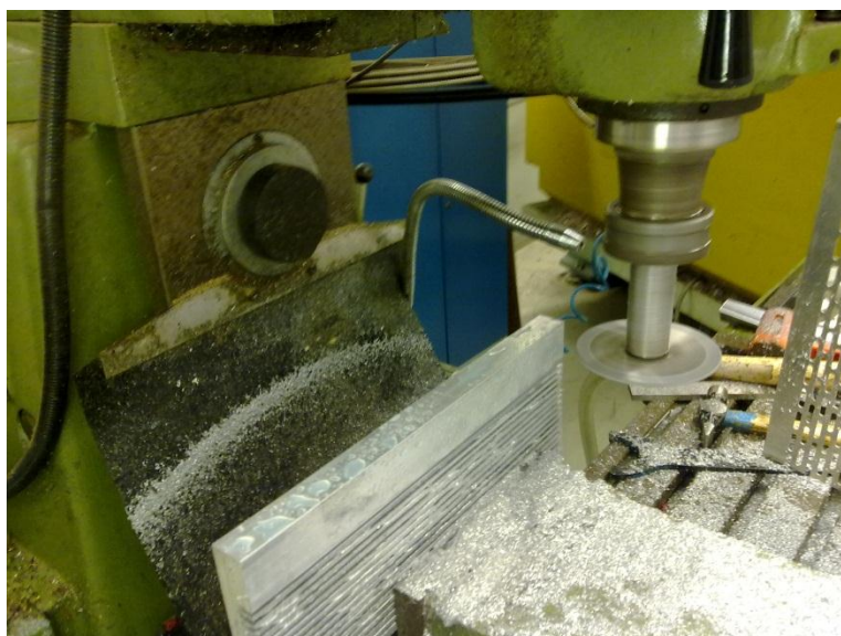
Bilde 3.5: Fresing av riller i aluminiumsribbene
