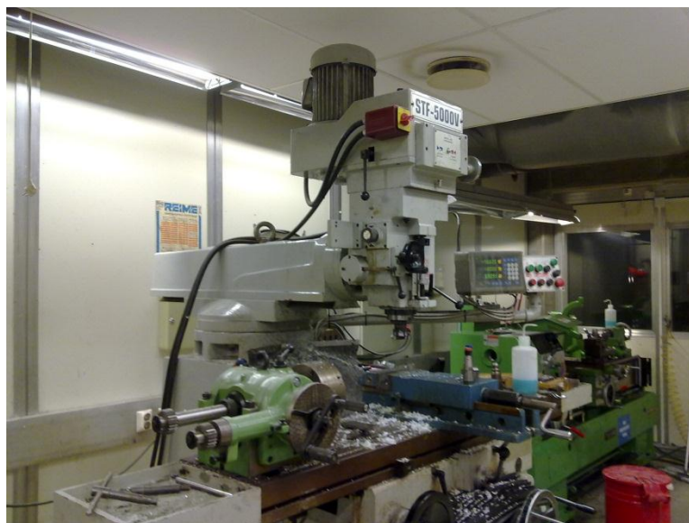
Bilde 3.1: Fresemaskinen brukt til freseoperasjonene
