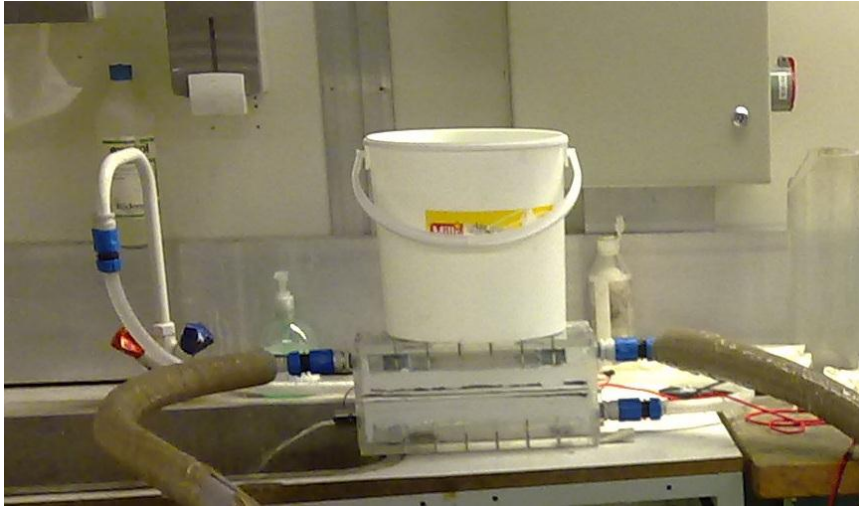
Bilde 4.4: Viser den ytre last i form av en bøtte med vann
