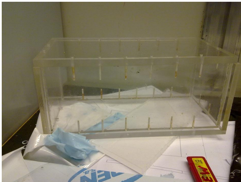
Bilde 3.4: Kabinettet etter fullført borreoperasjon
