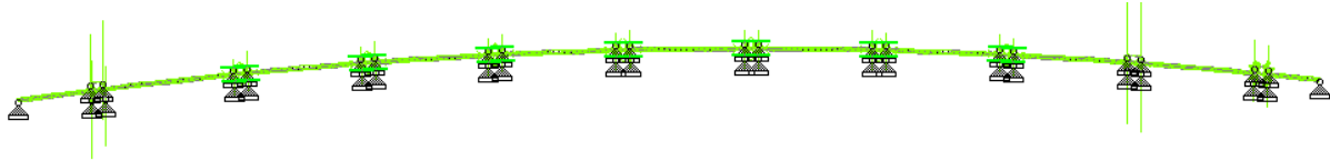
Figure 7-2: Momenter om z-aksen. Snapshot fra Staad.Pro
