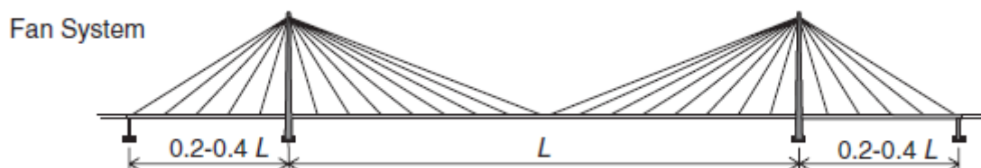
Figure 2-11: Viftekonfigurasjon på skråstagoverbygning (GIMSING and GEORGAKIS 2012)
