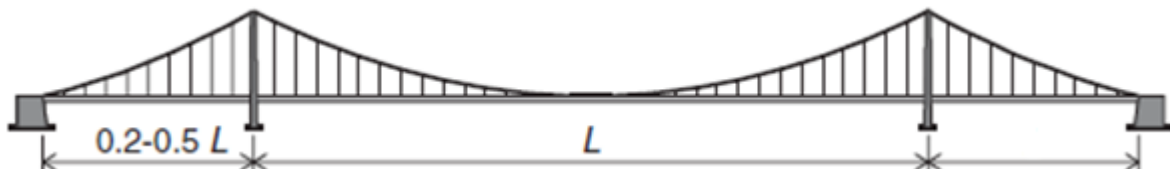
Figure 2-10: Illustrasjon av en typisk hengebro (GIMSING and GEORGAKIS 2012)
