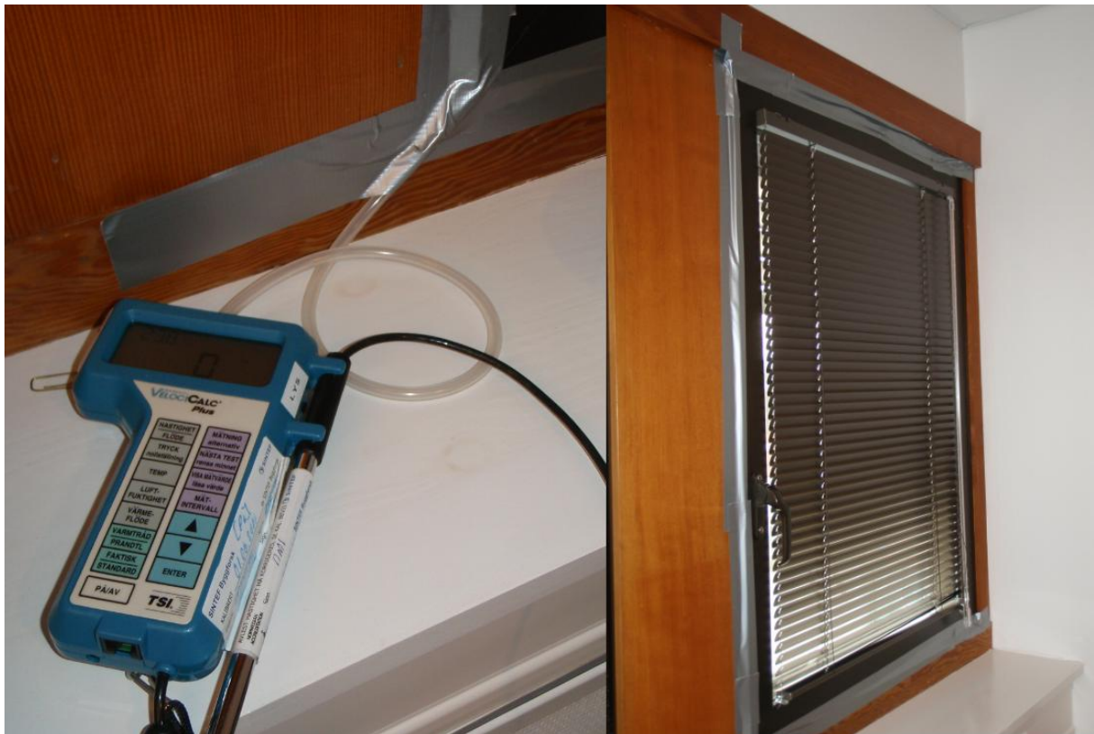
Figur 13. Måling av forskjell i trykk inne og ute. Disse bildene er hentet fra målinger gjort ved termografering hos Stavanger kommune 26. januar 2012. Fremgangsmåte og utstyr er det samme som ved trykkmålinger gjort på Gand vgs. samme dag.
