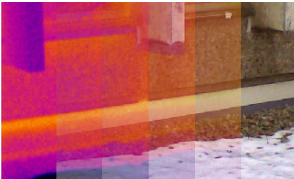
Figur 18. Kuldebro under brystningsplatene i andre etasje. ( T=3,1 °C, \epsilon=0,9 )
