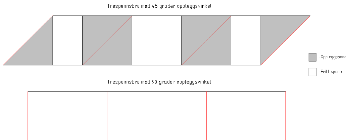
Figur 9-2 Spennlengder ved forskjellige opplagingsvinkler, screenshot fra Autocad
