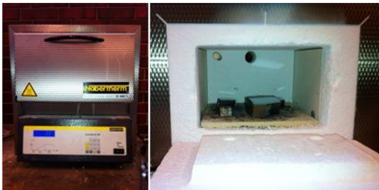
Figur 4.3: Ovn brukt ved spenningsgløding av utvalgte prøvestykker.
