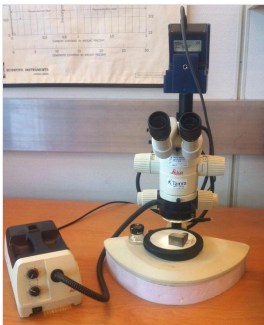
Figur 4.4: Stereolupe av typen Leica MZ 12,5.
