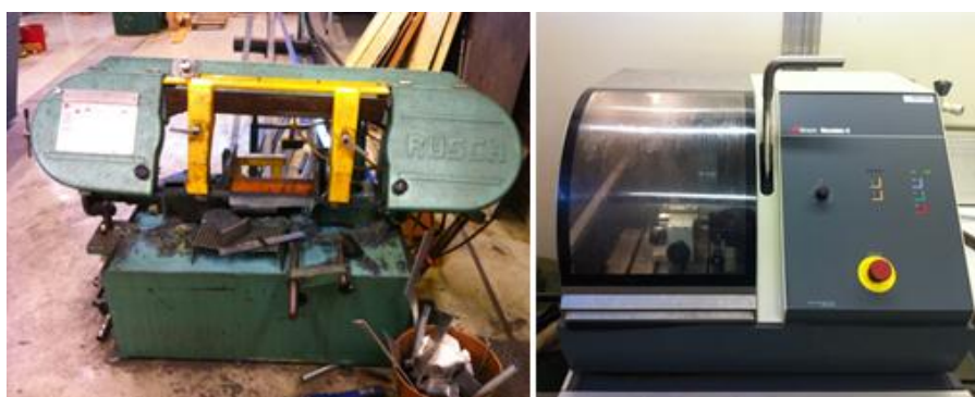
Figur 4.1: Maskiner som ble brukt til grovkutting (venstre bilde) og finkutting (høyre bilde) av prøvebiter
