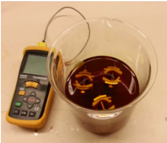
Figur 24: Prøvene i jernkloridløsning
