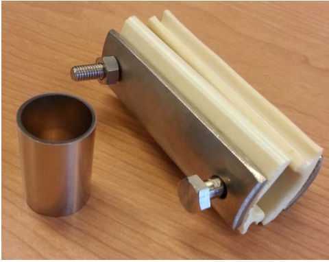
Figur 23: Prøve til korrosjonstest og prøveholder
