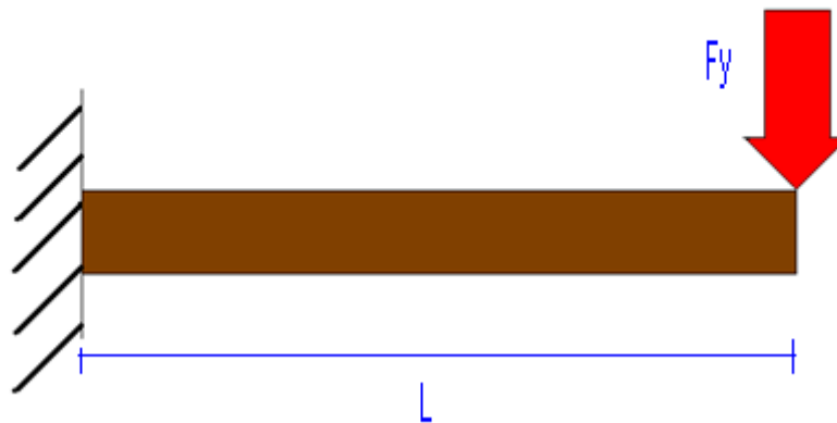
Figur 18: Nedbøyning av bjelke
