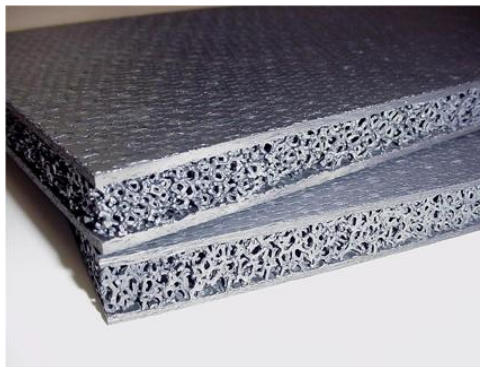
Figur 4.2: Sandwichkompositt utviklet av NASA[21]
