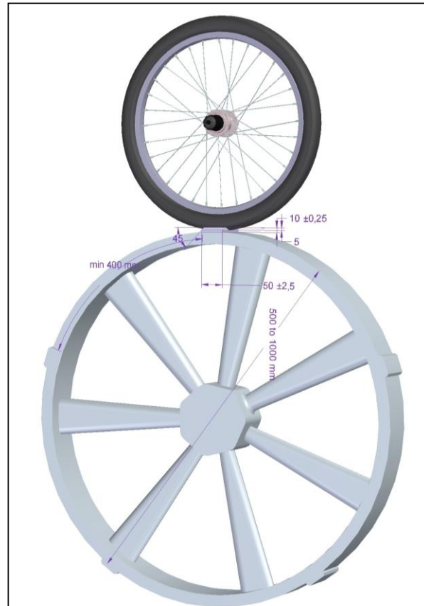
Figure 31 - EN 14764 Fatigue test jig
