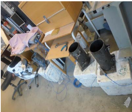
Figure 22 Måling av temperatur under betongherding
