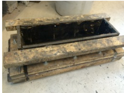
Figur 5.10 – Nominell størrelse for test bjelker [18] og bjelkeform
