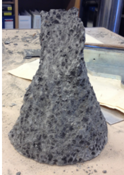
Figur 5.13 – Bruddform for LWAC-ref etter trykkfasthet prøving
