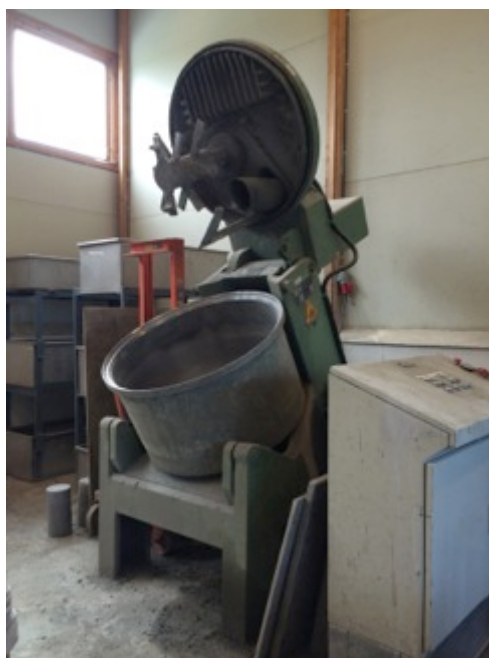
Figur 5.4 – Tvangsblender som ble brukt under prosjektet
