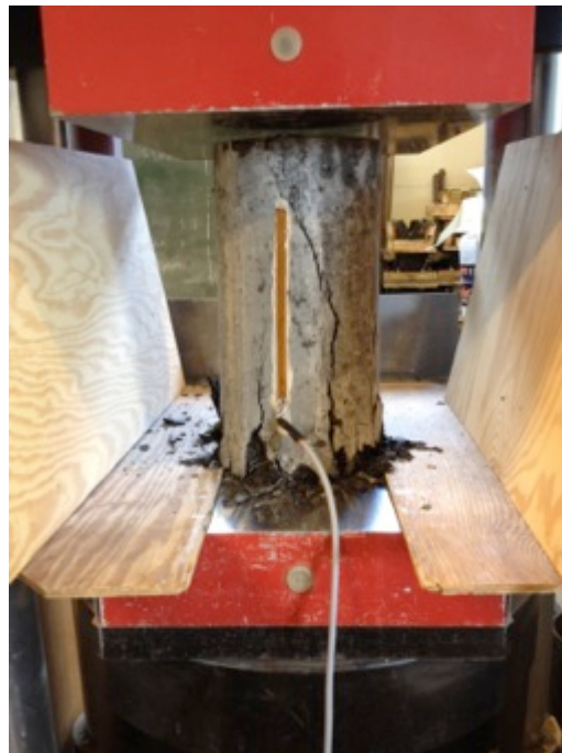
Figur 5.17 – Sylinder med strekkklapp etter endt prøving
