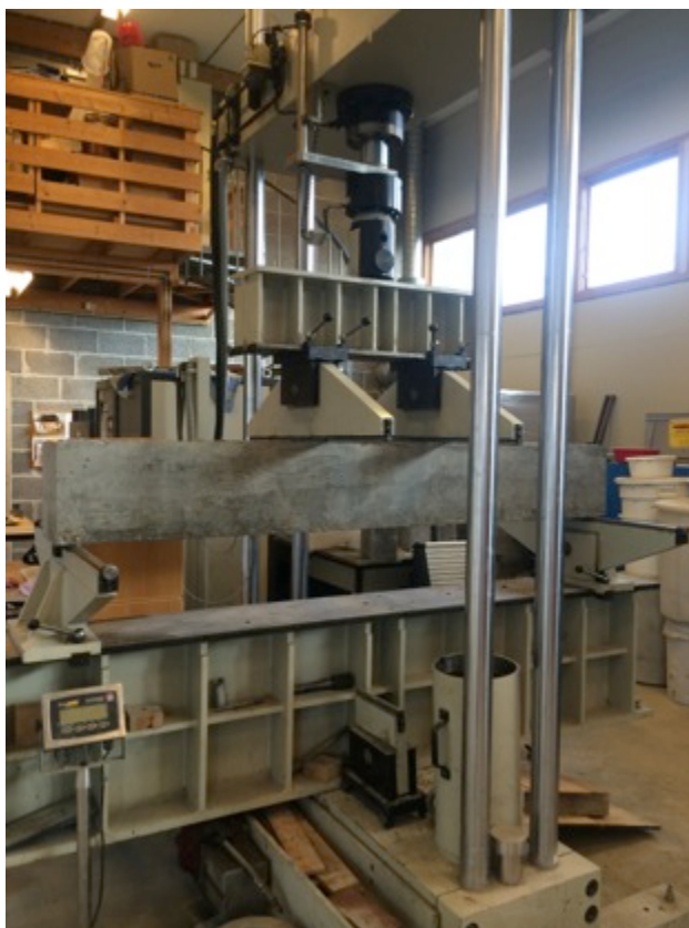
Figur 5.22 – Testjigg med plassert bjelke
