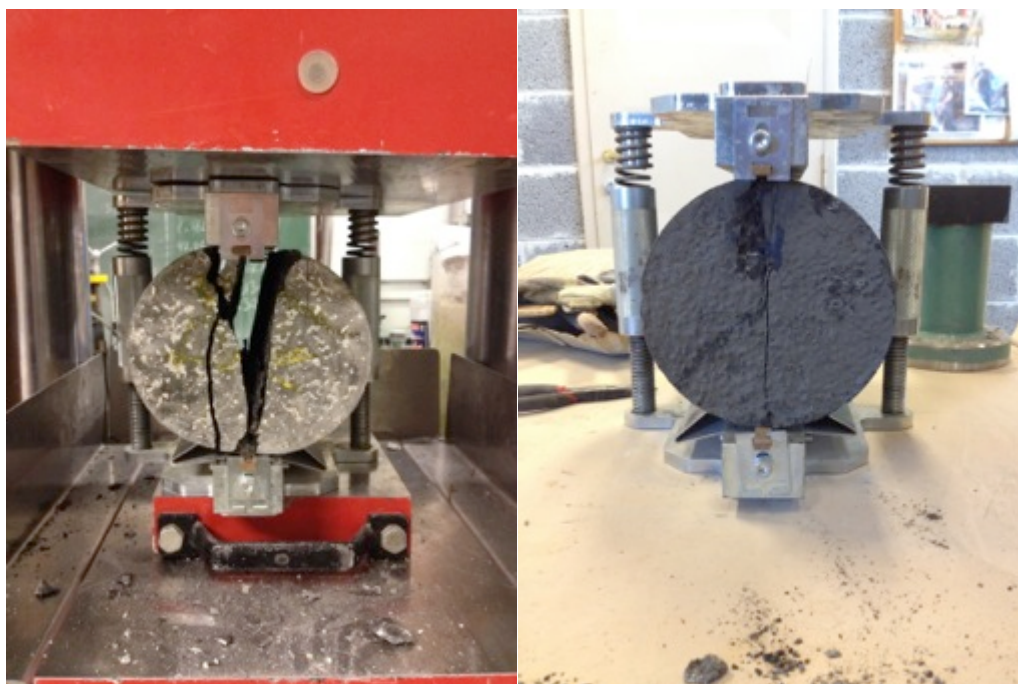
Figur 5.16 – Spaltestrekkforsøk av LWAC uten fiber til venstre og med stålfiber til høyre.
