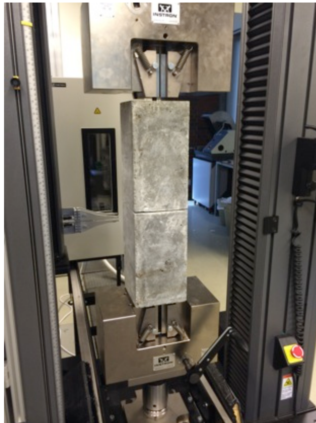
Figur 5.20 – Strekkbjelke med mål til høyre og innfestet bjelke i strekkmaskinen
