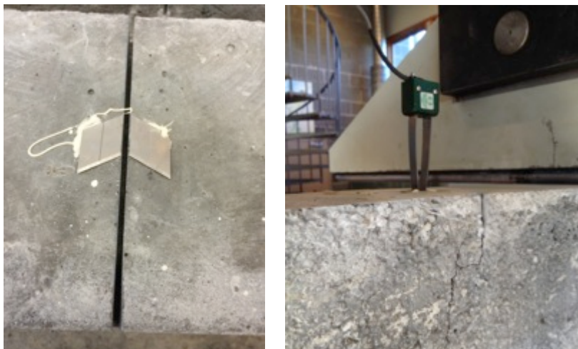
Figur 5.18 – Festeinnretning clip gauge t.v. og innfestet clip gauge på bjelke t.h.
