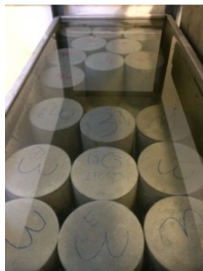
Figur 5.8 – Nominell størrelse på sylindere [18] og sylindere i vannbad
