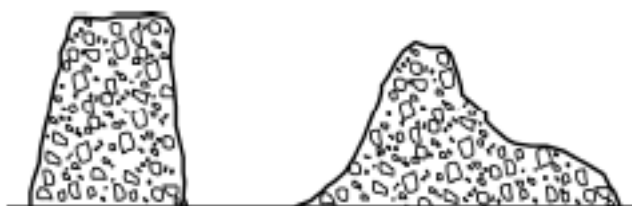
Figur 5.5 – Sant- og skjærdeformert synkmål [15]
