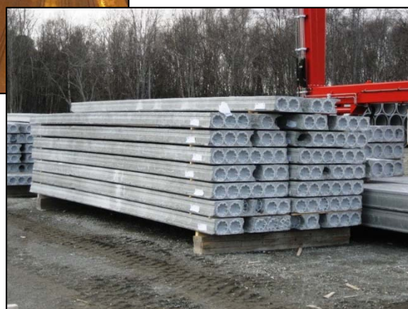
Figur 3.6: Ferdig produserte hulldekkeelementer [5]
