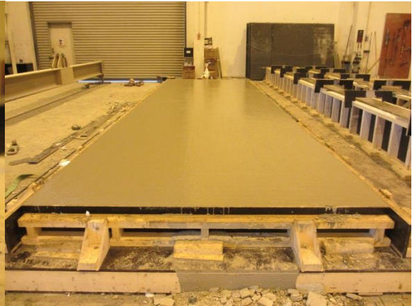
Vedleggsbilete 9 – Innersjikt i alle elementa blei jamna ut og glatta av
