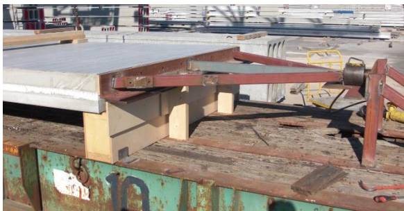
Vedleggsbilete 10 – Aksiallasta blir påført med hydraulisk jekk
