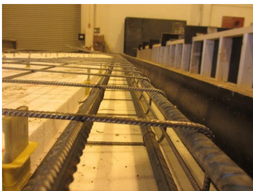
Bilete 2 – Søylesona i eit av elementa nytta i denne oppgåva
