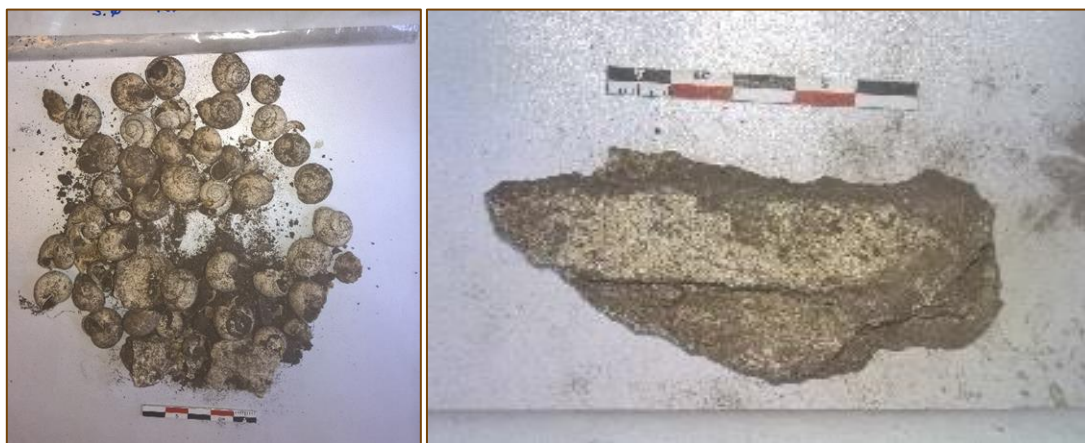
Figur 42(a): sneglehus fantes i murkjernen og (b): kalkpuss rester.
