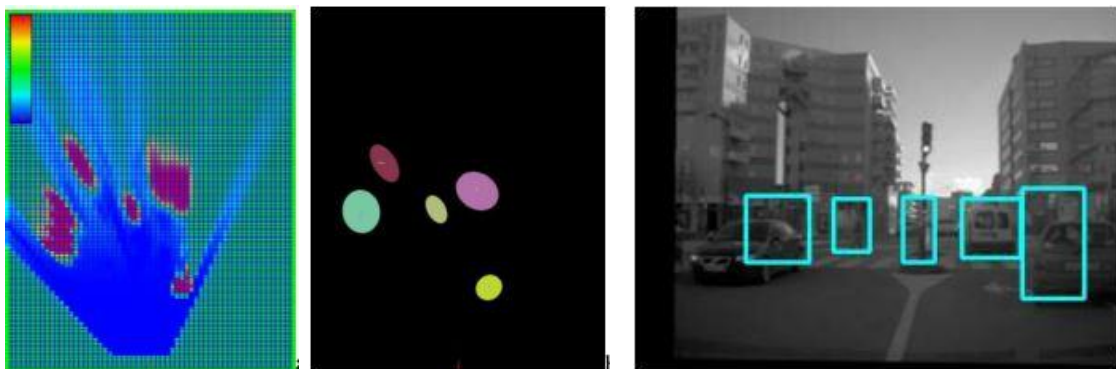
Figur 44 U-disparitet: Venstre: Estimert oversiktskart frå u-dispariteten. Midten: Detekterte objekt frå oversiktskartet. Høgre: Dei detekterte objekta er projeksjonert over det venstre stereobildet. Bilda er henta frå [66]
