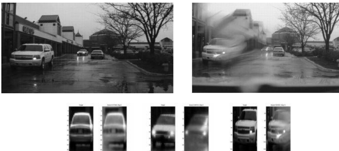
Figur 48 Stereoassistanse: Øvst: Venstre og høgge bilde ifrå stereokamera der høgge kamera opplever ei forvringing pga. vatn på ruta. Nedst: Kwart av køyretøya er detektert i kvart av bilda. Bilda er henta frå [71].
