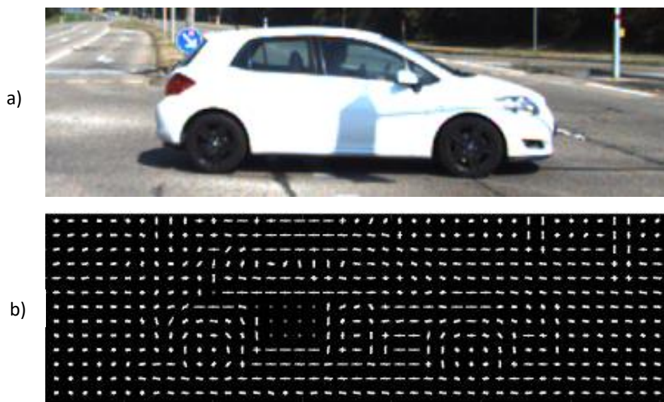
Figur 21 HOG-deskriptor: a) Bildet som skal bli prosessert. b) Kvart av dei kvite objekta viser gradientens retning og lengde i ei 8x8 celle. Rundt køyretøyets kantar er det tydelege forskjellar i orienteringa til gradienten.
