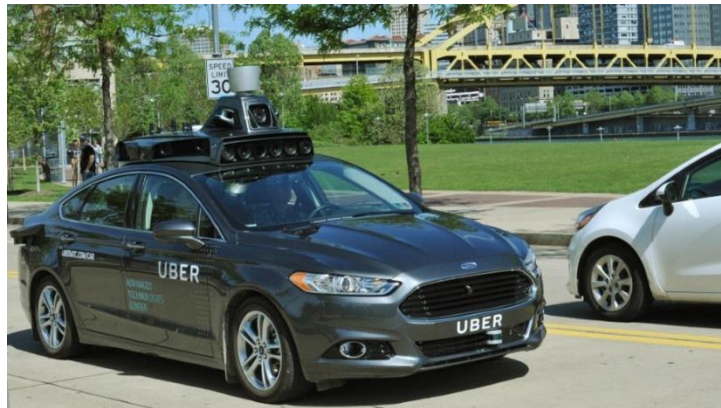
Figur 39 Uber sin autonome bil kartlegg gatene med lidar utvikla av Velodyne. Bilde er henta frå [48].
