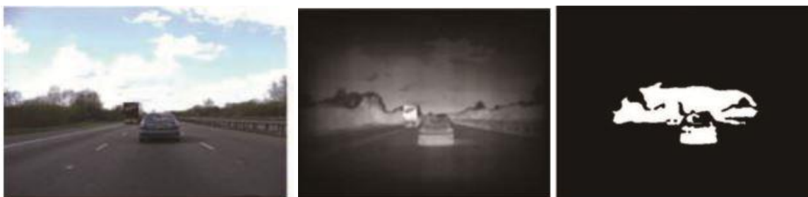
Figur 42 Saliency map: Venstre: Input av eit køyretøy. Midten: gråskalert saliency kart. Høgre: Segmentert bilde som framhevar området der kandidaten for verifisering er i bildet. Bilda er henta frå [62].
