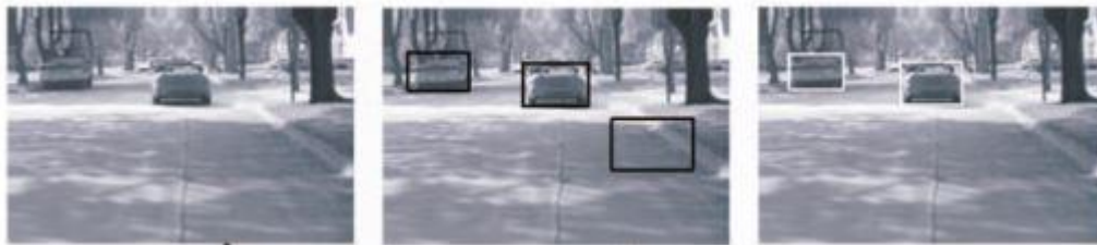
Figur 38: Venstre: To køyretøy er synlege i bildet. Midten: Ulike element i bildet er detektert ved HG. Bildet syner eit område som er feildetektet. Høgre: Element i bildet er verifisert som køyretøy ved HV. Bilda er henta frå [4].
