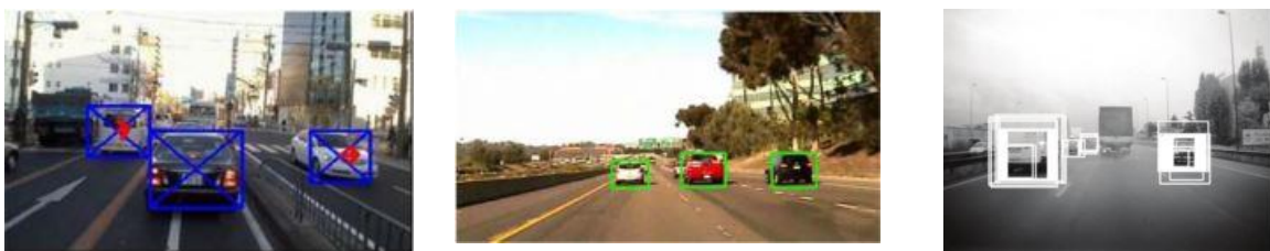
Figur 40 Ulike resultat frå deteksjon av køyretøy: Venstre: HOG-eigenskapar[54]. Midten: Haar-eigenskapar[28]. Høgre: Fusjon av HOG -og Haar-eigenskapar[57].
