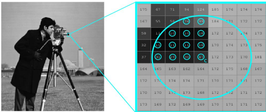
Figur 2.21 Viser SUSAN-masken på et ekte bilde med terskelverdien t satt til 47. Piksler godkjent som en del av USAN-området er markert med sirkler, c er senterpiksel (nukleonet).
