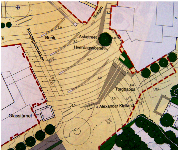
Figur 2.31: Planforslaget i høringsforslaget her ser man asketreet på hverdagsscene, torgtrappen, vannrennene, glasstårnet, vannposten mm. (Stavanger kommune, 2001, s. 43)
