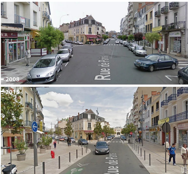
Figur 3.9 Fjerning av gateparkering til fordel for fotgjengere og syklistene i Vichy, Rue de Paris, Frankrike. Kilde: Urb-i
