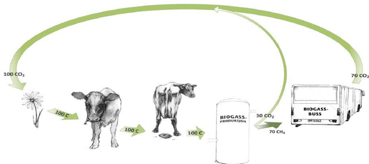
Figur 4: Illustrasjon av kretsløpet og klimagassutslipp med biogassproduksjon benyttet til drivstoff 4
