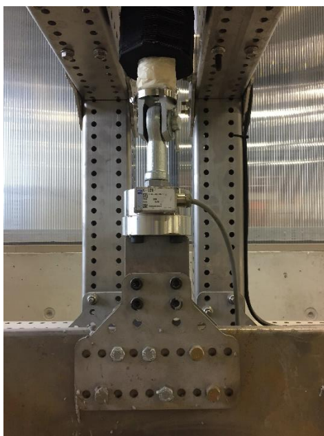
Figur 16 – Lastsensor for registrering av løftkraft (Bjerkestrand, 2017 .
