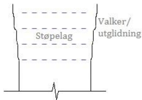
Figur 8 – Illustrasjon av valker/utglidning ved etter glidestøp (Bjerkestrand, 2017).
