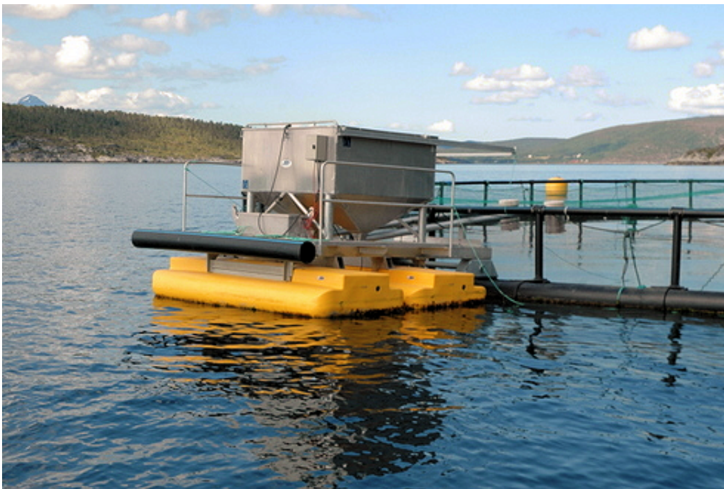
Figure 2.3: Local feeding system (Betten Maskinstasjon, 2016)
